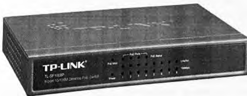
Εικόνα 2-7 - Τα Power Over Ethernet switches του δικτύου
