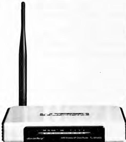
Εικόνα 2-8 – Access Point TP-Link TL-WR543G
