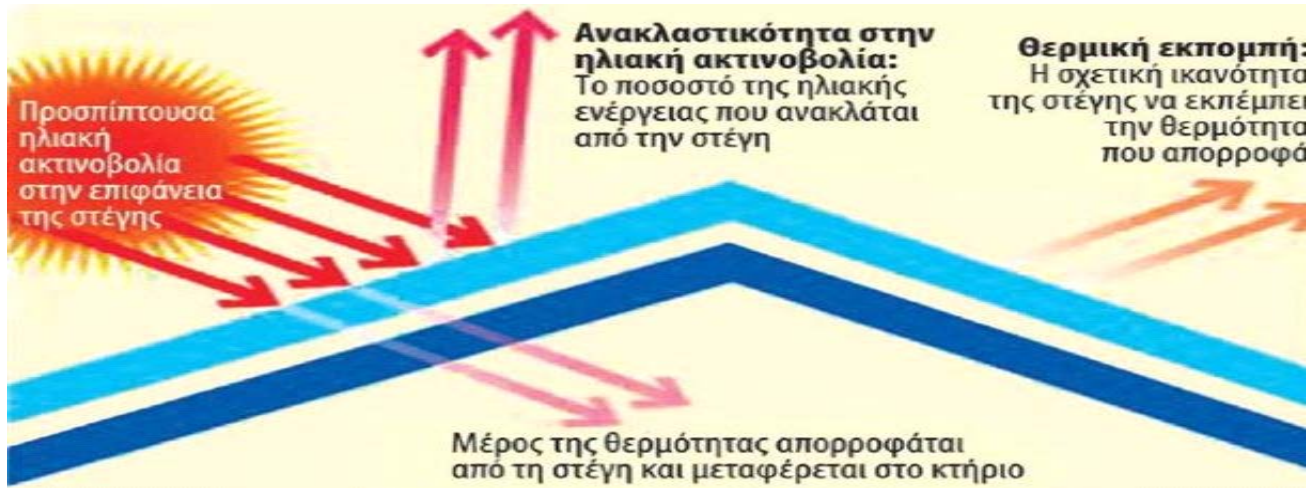
Εικόνα: Μετάδοση θερμότητας προς την στέγη κτηρίου
