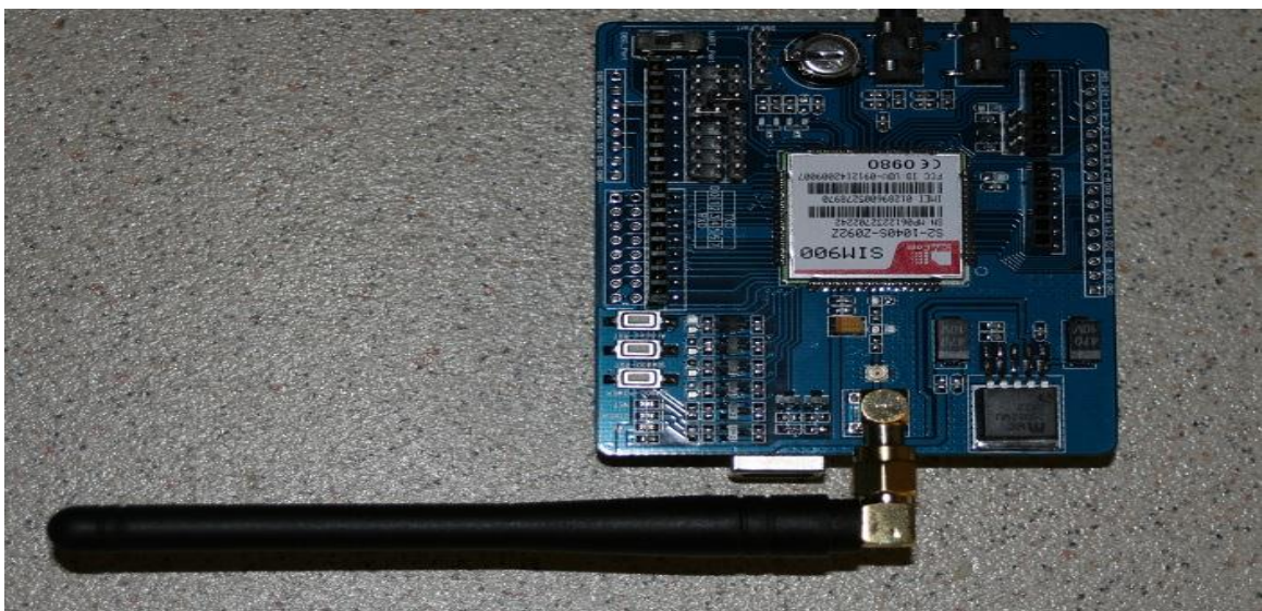
Εικ. 3.3 Arduino UNO Icomsat v1.1 SIM900 GSM Module Στέλνει SMS
