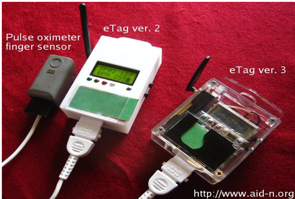
Εικ. 1.4 UVA / N-AID "ETAG" ασύρματες ετικέτες διαλογής, με παλμικό οξύμετρο, φωτεινές ενδείξεις κατάστασης των data του ασθενούς, και κουμπιά ελέγχου.
