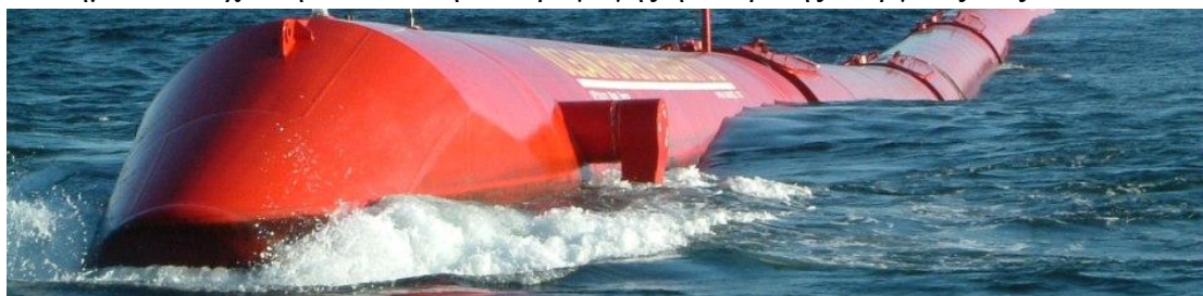
Σχήμα 1.6 - Σύστημα Pelamis εν ώρα λειτουργίας
