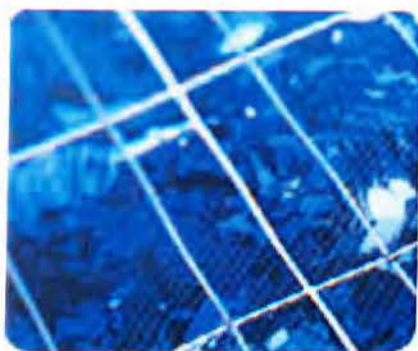
Σχήμα 2.2.3 Φωτοβολταϊκό στοιχείο πολυκρυσταλλικού πυριτίου, [2.4]
