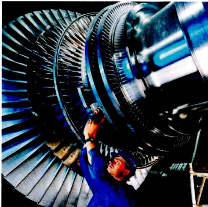
Σχήμα 3.11: Αντικατάσταση πτερυγίων ενός Ατμοστρόβιλου
