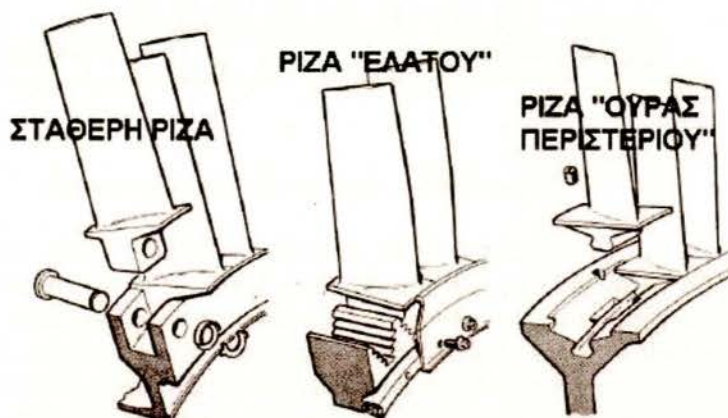
Σχήμα 2.19: Τρόποι συναρμογής κινητών πτερυγίων συμπιεστή
