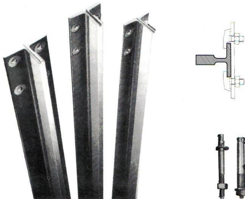
Σχήμα 4.37 (α) Μορφή οδηγών ζυγών ανελκυστήρα, (β) Στήριξη οδηγών σε αντίστοιχο εξάρτημα, (γ) Στηρίγματα πάκτωσης στο φρεάτιο Φ12, Φ16 αντίστοιχα.
