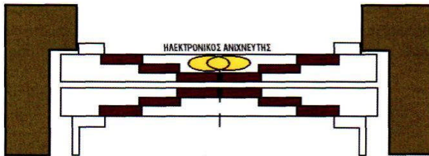
Σχήμα 4.23 Ηλεκτρονικός έλεγχος θυρών
