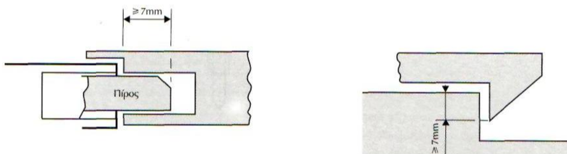
Σχήμα 4.6. Παραδείγματα στοιχείων μανδάλωσης
