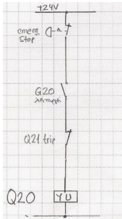
Σχ.11f- Αλληλομανδαλώσεις ΑΔ Q20 μέσω πηνίων έλλειψης τάσης(YU)
