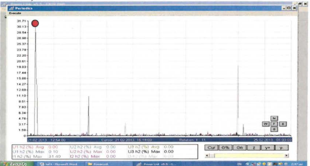
Εικόνα 4.29 Ανάλυση τιμών (periodics) (Ph1~ Uh2, Ih2 / Ph2~ Uh2, Ih2 / Ph3~ Uh2, Ih2) GXER
