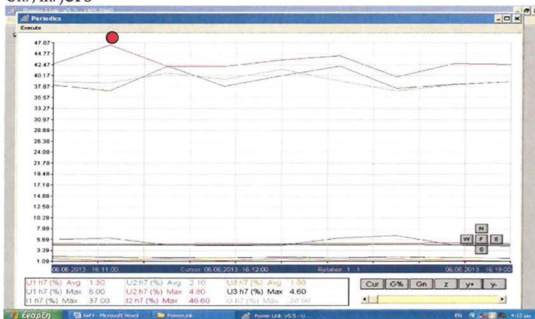
Εικόνα 4.52 Ανάλυση τριών (periodics) (Ph1~ Uh7, Ih7 / Ph2~ Uh7, Ih7 / Ph3~ Uh7, Ih7)UPS
