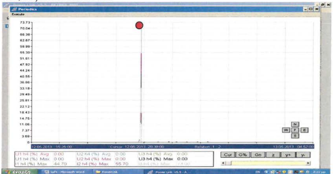
Εικόνα 4.22 Ανάλυση τιμών (periodics) (Ph1~ Uh4, Ih4 / Ph2~ Uh4, Ih4 / Ph3~ Uh4, Ih4)AKTINOLOGIKO
