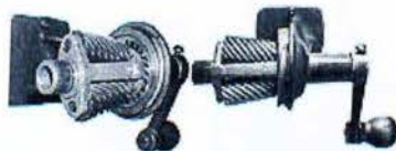
Εικόνα 5.4: Μια πλανητική ξύστρα (το περίβλημα αφαιρεθεί για να αποκαλυφθεί ο μηχανισμός).
