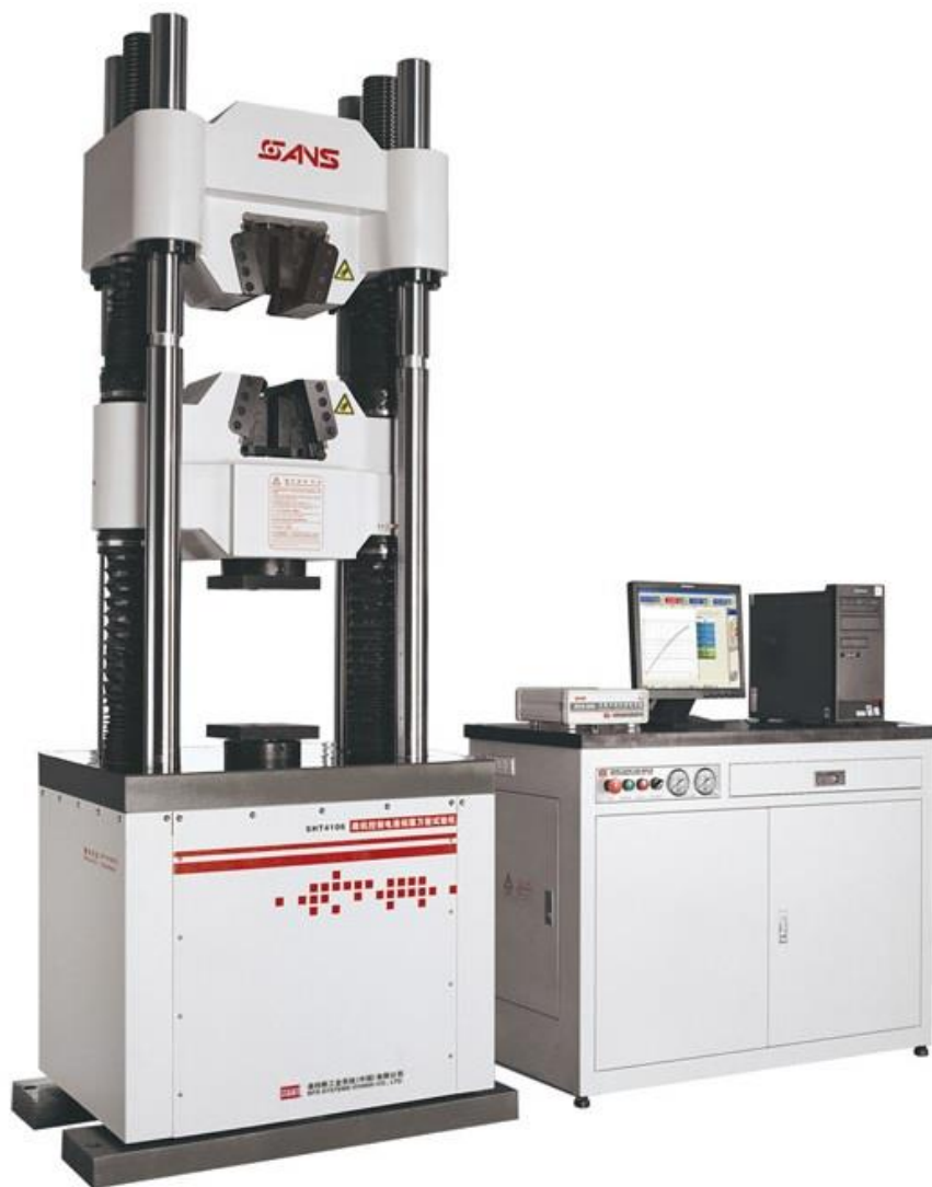
Σχ. 2.3 Σερβοϋδραυλική συσκευή εφελκυσμού
