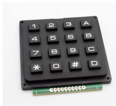
Εικόνα 3.3. Αριθμητικό Πληκτρολόγιο (Keypad).
