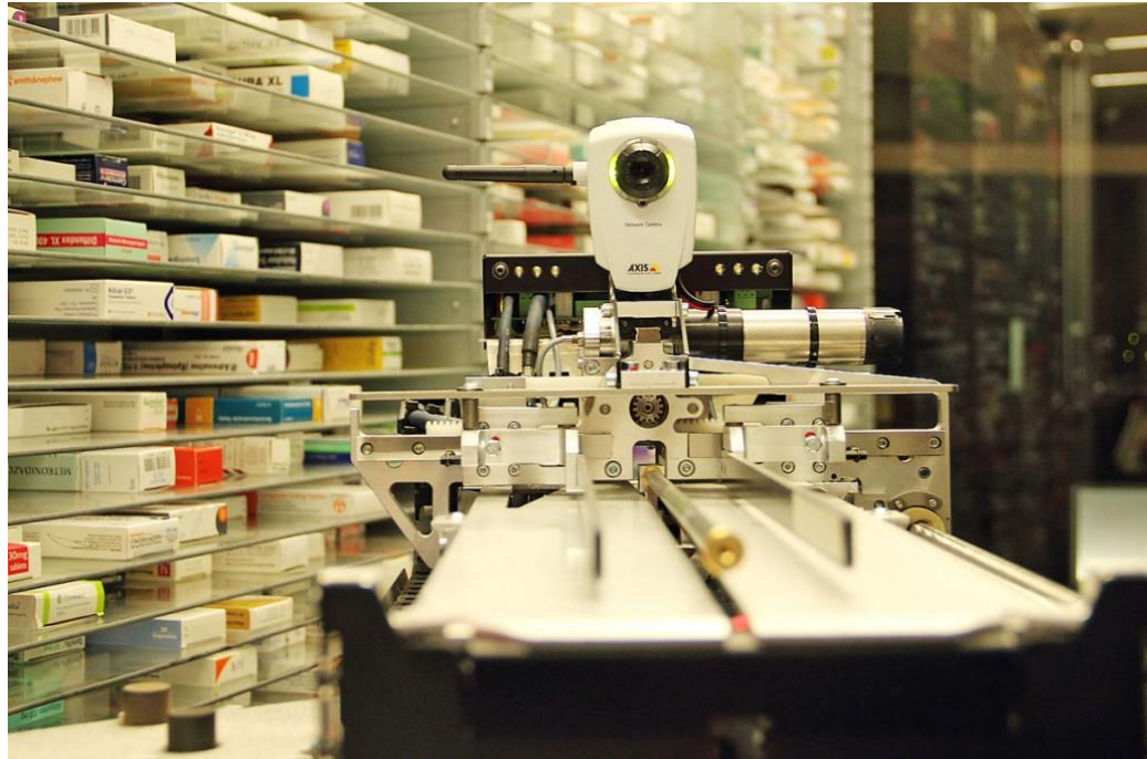
Εικόνα 2.3. Ρομποτικός Συσκευαστής Φαρμακείου.
