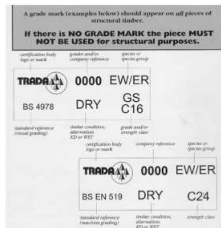
Εικόνα 17: Απαραίτητη η ειδική σήμανση για κάθε ξύλινο μέλος.
