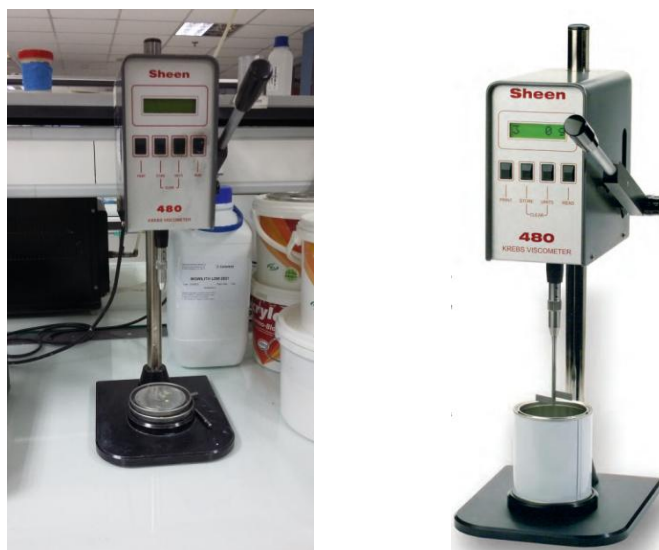
Εικόνα 2.4 Ιξωδόμετρο με Krebs (KU) (φωτογραφία από το εργαστήριο της εταιρείας Vitex - ΑΦΟΙ ΓΙΑΝΝΙΔΗ)
