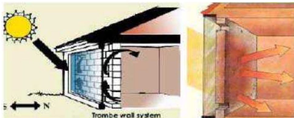
Σχήμα 9.1.8. Απεικόνιση και περιγραφή της λειτουργία του τοίχου Trombe
