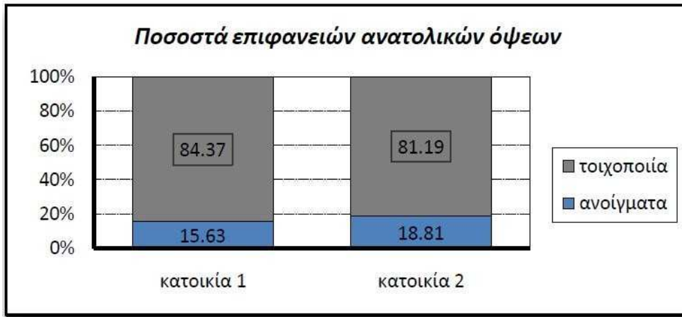
Διάγραμμα 9.1.3: Ποσοστά επιφανειών στην ανατολική όψη κάθε κατοικίας. Στη συνέχεια παρουσιάζονται τα σχέδια της ανατολικής όψης των κατοικιών και κατόπιν αναλύονται οι βασικές κατευθύνσεις που ακολουθήθηκαν κατά το σχεδιασμό.
