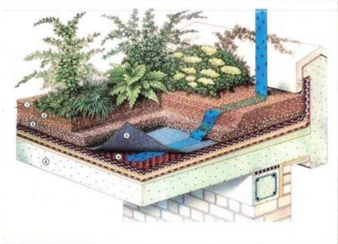
Εικόνα 5.24 ο Σχηματική Τομή Φυτεμένου δώματος
