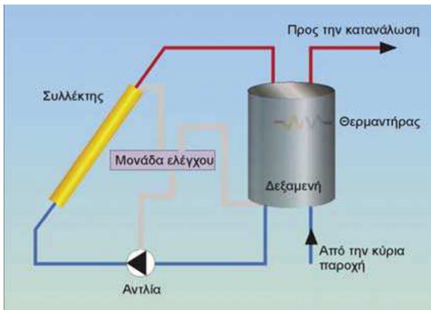
Εικόνες 4.2, 4.3 Ηλιακή εγκατάσταση θέρμανσης νερού με εξαναγκασμένη κυκλοφορία
