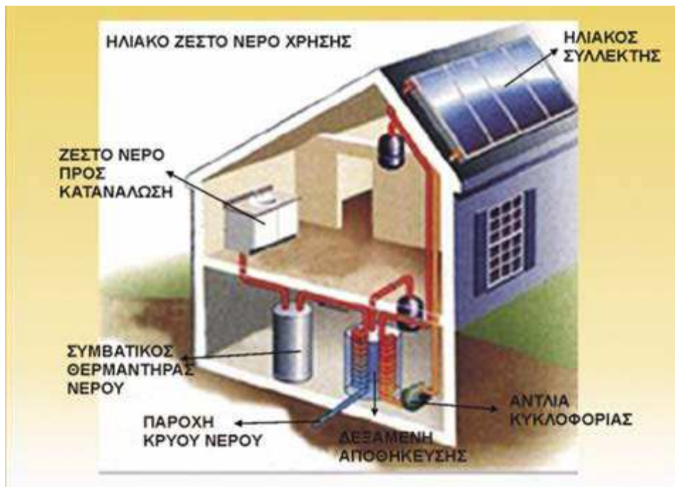
Εικόνα 4.4 Ολική εγκατάσταση ζεστού νερού
