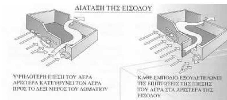
Εικόνα 5.9. Ο ρόλος των εξωτερικών στοιχείων στον αερισμό του εσωτερικού χώρου
