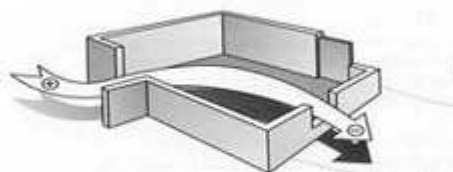
ΧΡΗΣΗ ΠΑΡΑΘΥΡΩΝ ΜΕ ΕΞΕΦΥΛΑΑ ΓΙΑ ΚΑΘΟΔΗΓΗΣΗ ΤΟΥ ΑΕΡΑ ΜΕΣΑ ΣΤΟ ΧΩΡΟ
