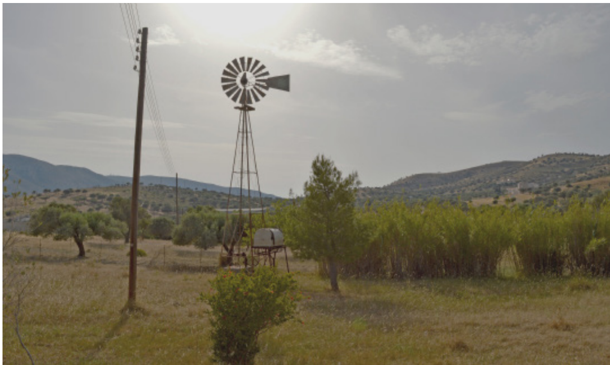
εικ. 1.16α Πολυπτέριγη α/γ για άντληση νερού στην περιοχή Κουβαρά Αττική - Αμερικάνικος ανεμόμυλος, μια από τις πιο πετυχημένες κατασκευές αξιοποίησης αιολικής ενέργειας πηγή : Προσωπικό αρχείο
