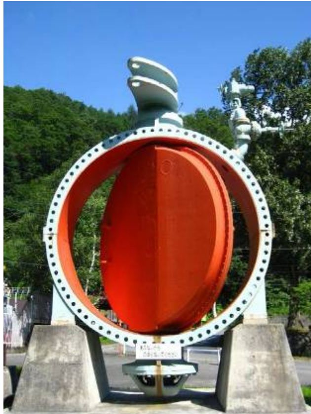
Σχήμα: 3.2-2: Butterfly βάνα που χρησιμοποιήθηκε στην Ιαπωνία σε Υδροηλεκτρικό σταθμό
