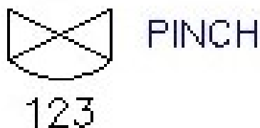
Σχήμα: 3.12-2: Μηχανολογικό Σύμβολο βάνας τύπου Pinch
