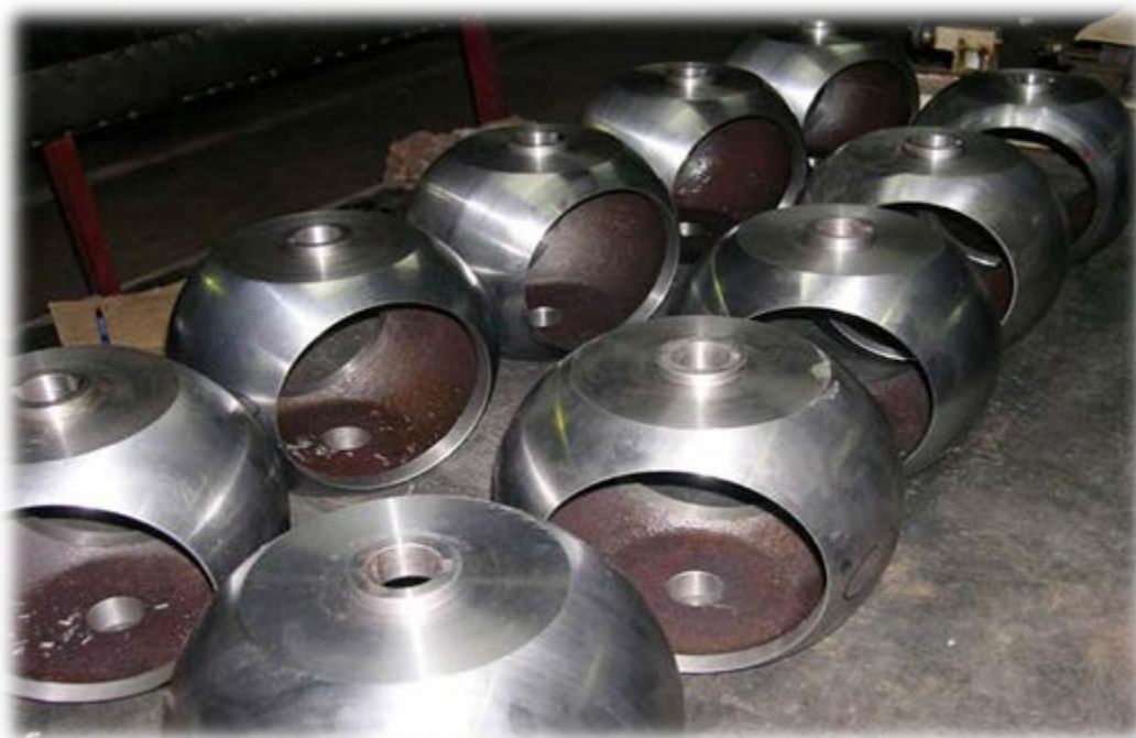
Σχήμα: 3.1-2: Κράμα κελύφους βάνας
