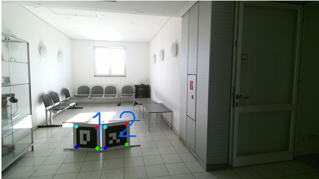
Εικόνα 4.4.1: Επιτυχής ταυτοποίηση των AprilTags
