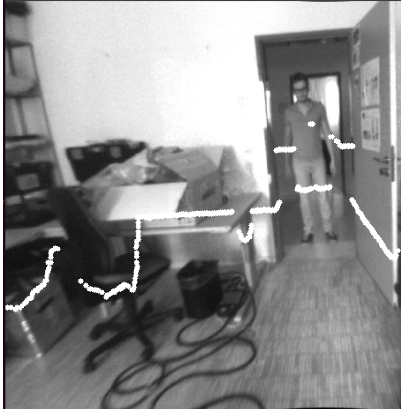
Εικόνα 4.4.4: Απεικόνιση σημείων laser με εμπόδια στον χώρο
