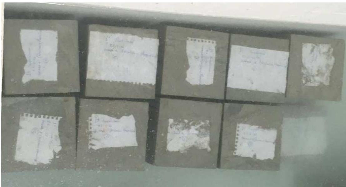
Εικόνα 9 Τα δοκίμια πριν και μετά το ξεκαλούπωμα
