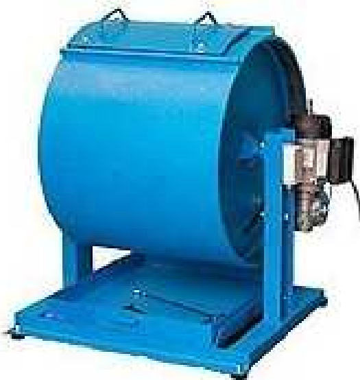
Εικόνα 11H μηχανή Los Angeles
