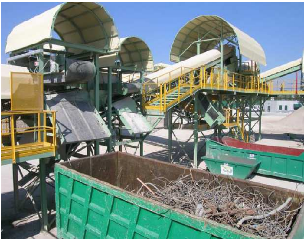
Εικόνα 4 Μαγνητικός διαχωριστής σε σταθερή μονάδα ανακύκλωσης στην Πίζα, Ιταλία. Το μαγνητικό προϊόν ανακτάται ως μεταλλικό scrap 12
