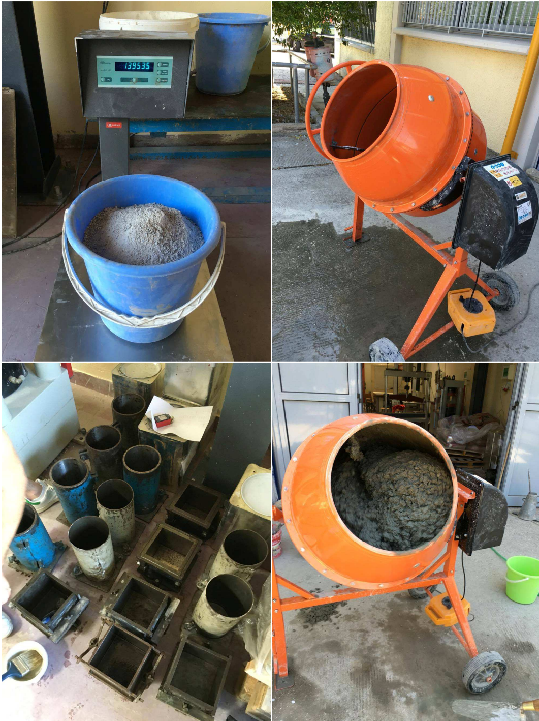
Εικόνα 8 Διαδικασία και υλικά για την κατασκευή των δοκιμίων
