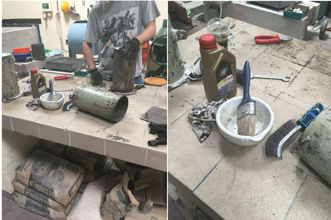
Εικόνα 10 Διαδικασία καθαρισμού και λίπανσης των καλουπιών
