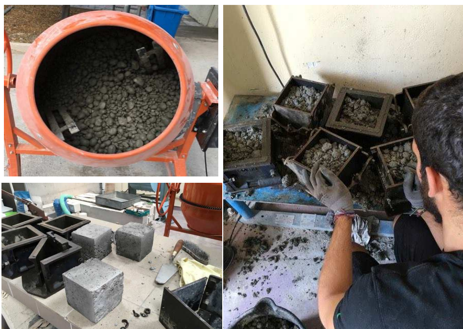
Εικόνα 15 Στιγμιότυπα από την διαδικασία της σκυροδέτησης, του καλουπώματος και του ξεκαλουπώματος
