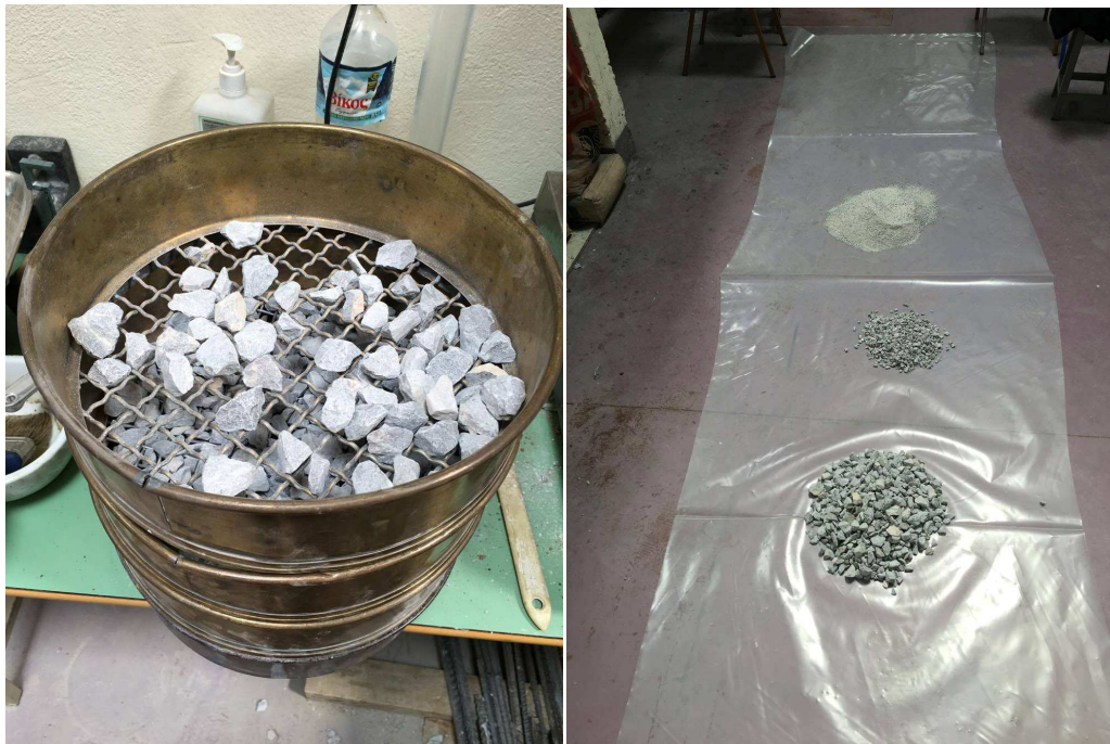
Εικόνα 13 Κοσκίνιση και διαβάθμιση υλικού στη μηχανή κοσκινίσματος
