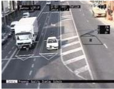
Εικόνα 1.24: Ανίχνευση αναμένοντων οχημάτων σε σηματοδότη.
