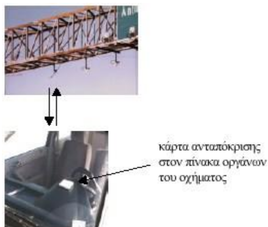
Εικόνα 1.26: Λειτουργία συστήματος παρακολούθησης με κάρτες ανταπόκρισης οχημάτων.
