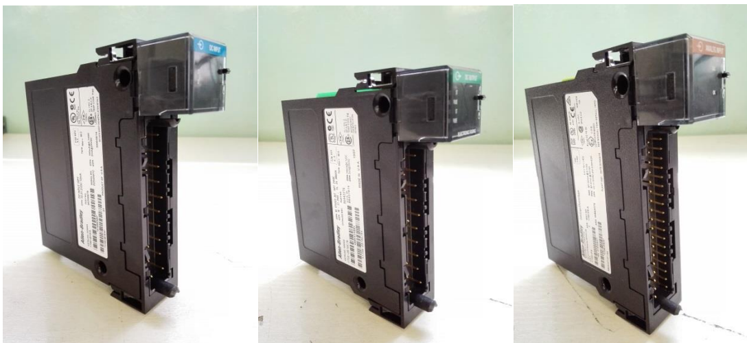
Εικόνα 2.5: 1) Κάρτα ψηφιακών εισόδων. 2) Κάρτα ψηφιακών εξόδων 3) Κάρτα αναλογικών εισόδων.
