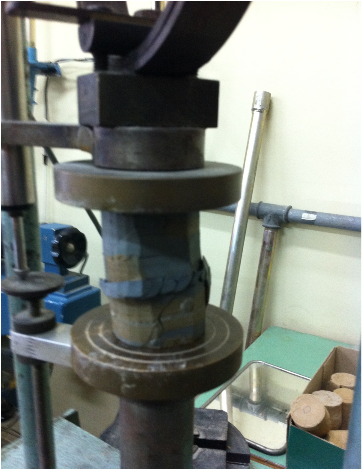
Εικόνα [8]: Κυλινδρικό δοκίμιο κατά την διάρκεια δοκιμής σε κατάσταση θράυσης
