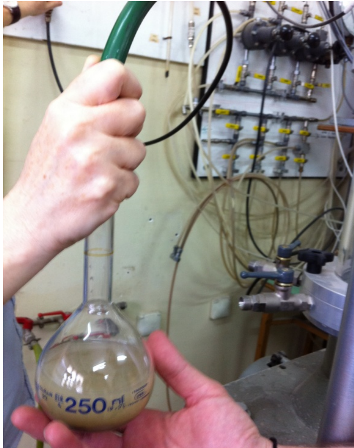
Εικόνα [9]: Γυάλινη φιάλη κατά την απομάκρυνση του εγκλωβισμένου αέρα.
