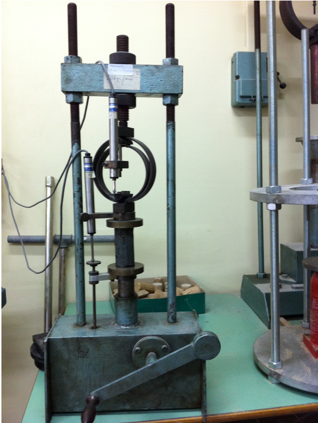
Εικόνα [3] :Συσκευή (πρέσα) Δοκιμών Ανεμπόδιστης Θλίψης
