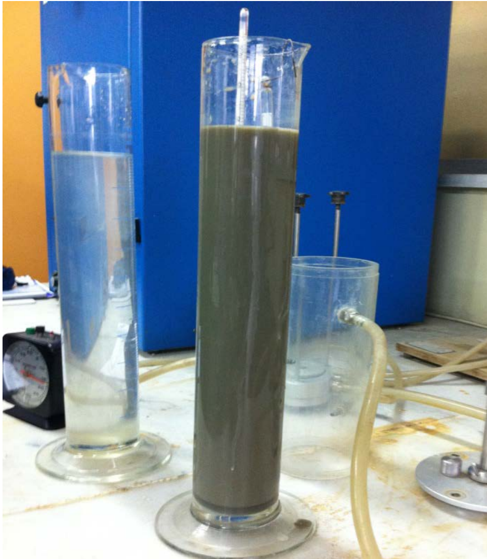
Εικόνα [13] Κατά την διαδικασία λήψης των μετρήσεων με το πυκνόμετρο
