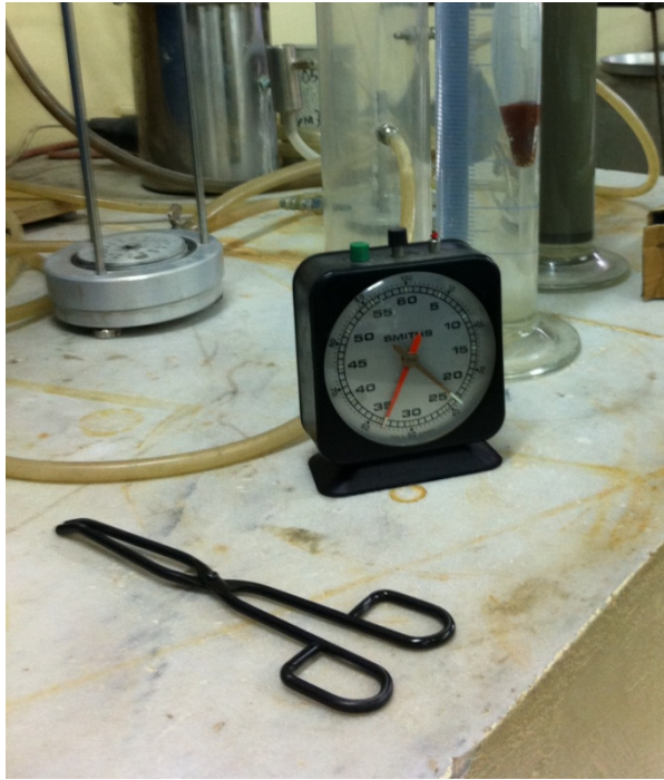
Εικόνα [4] : Χρονόμετρο (χρησιμοποιείται για να μην ξεπεράσει η δοκιμή τα 10 λεπτά αλλά και για την χειροκίνητη λειτουργία της συσκευής ανεμπόδιστης θλίψης ώστε να κρατάμε σταθερή ταχύτητα σε αναλογία με τον χρόνο)
