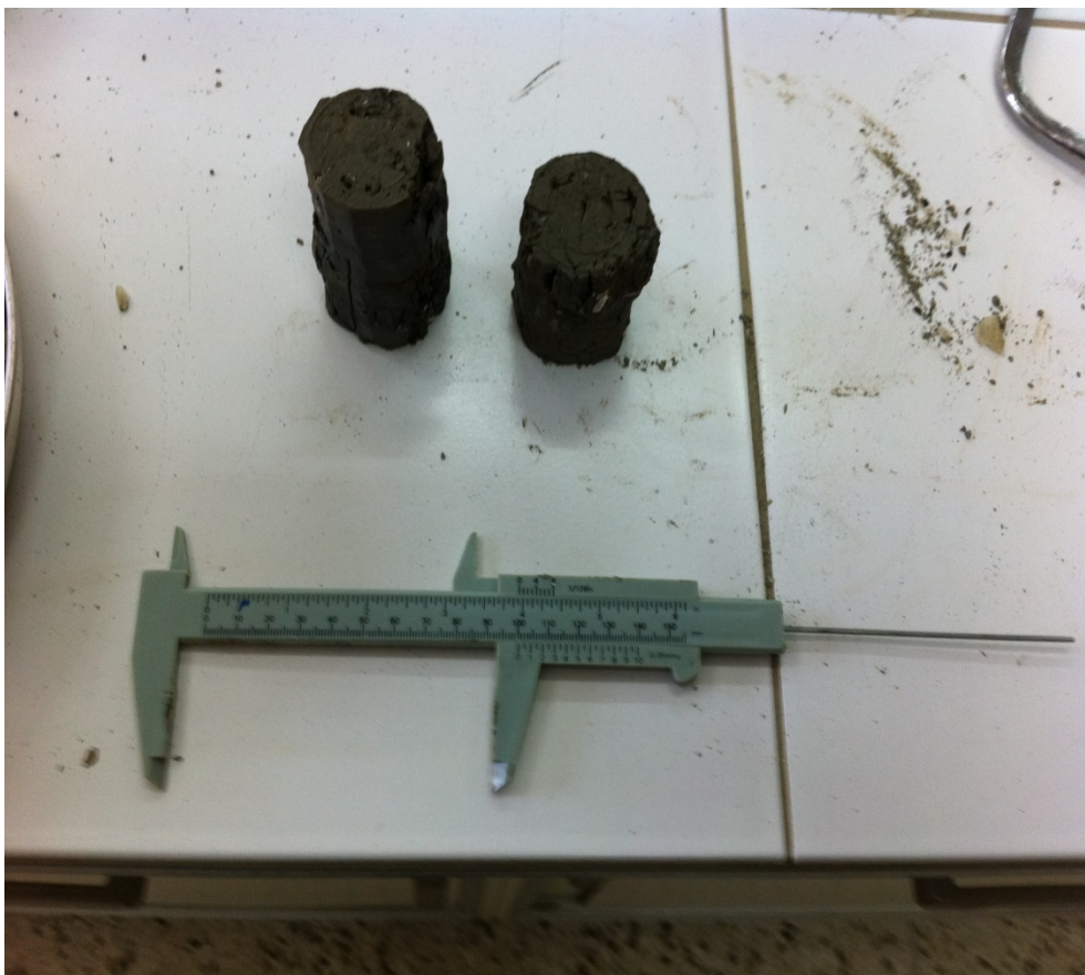
Εικόνα [5]: Παχύμετρο ( χρησιμοποιείται για τις μετρήσεις του ύψους και της διαμέτρου του δοκιμίου)
