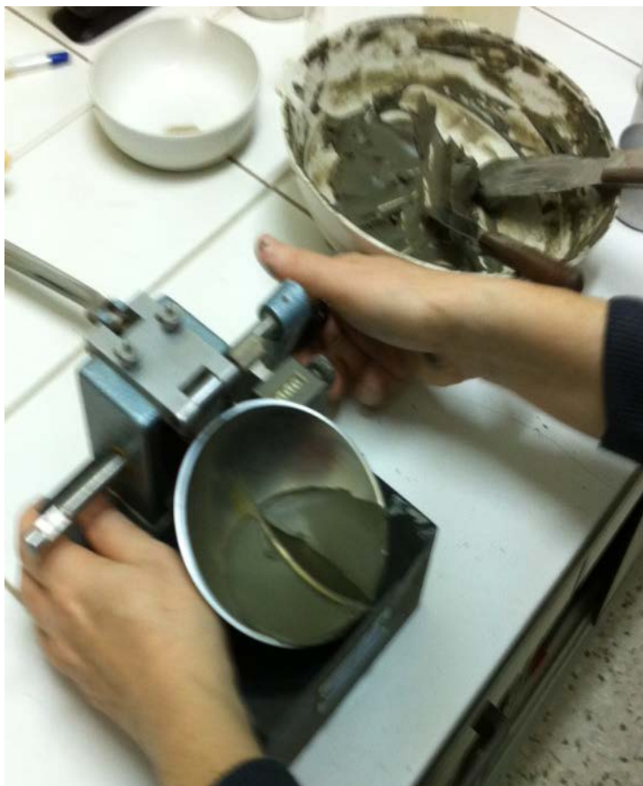
Εικόνα [11]: Το εδαφικό δείγμα έχει τοποθετηθεί στην συσκευή Casagrande και είναι έτοιμο να ξεκινήσουμε την δοκιμή.
