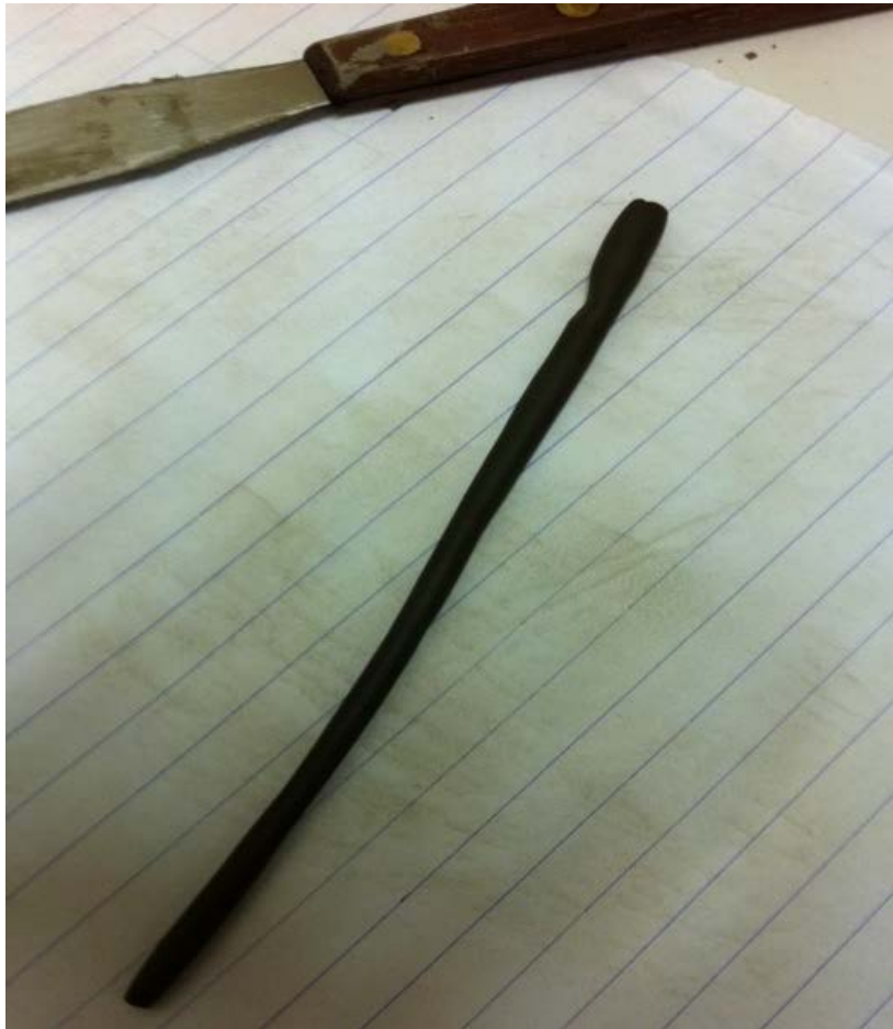
Εικόνα [12]: Ραβδίσκος κατά την εκτέλεση της δοκιμής για τον υπολογισμό του ορίου πλαστικότητας.
