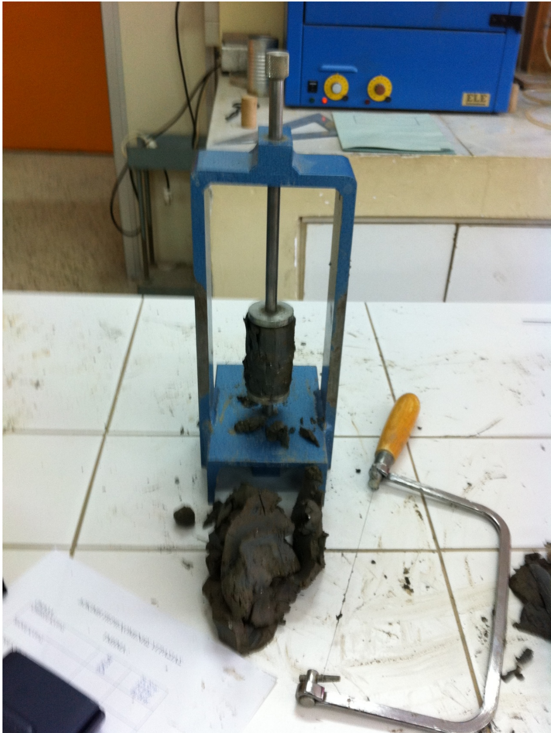
Εικόνα[6] :Μορφοποιητής αδιατάρακτου δοκιμίου (τόρνος εδάφους) & εργαλείο κοπής εδάφους
