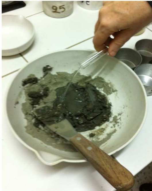
Εικόνα [10]: Ανάμιξη εδαφικού δείγματος με απεσταγμένο νερό.
