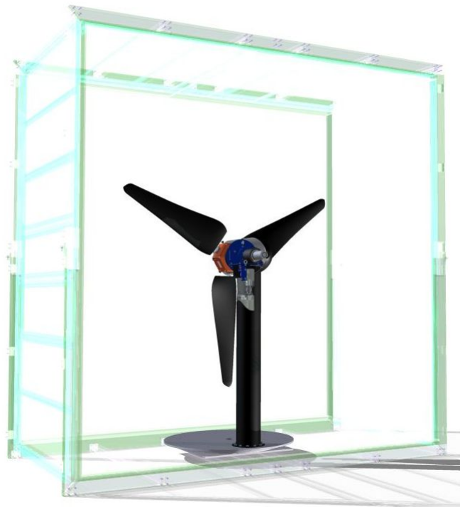
Σχήμα 3.3: 3-D Cad σχέδιο της ερευνητικής ανεμογεννήτριας μέσα στην αεροδυναμική σύραγγα
