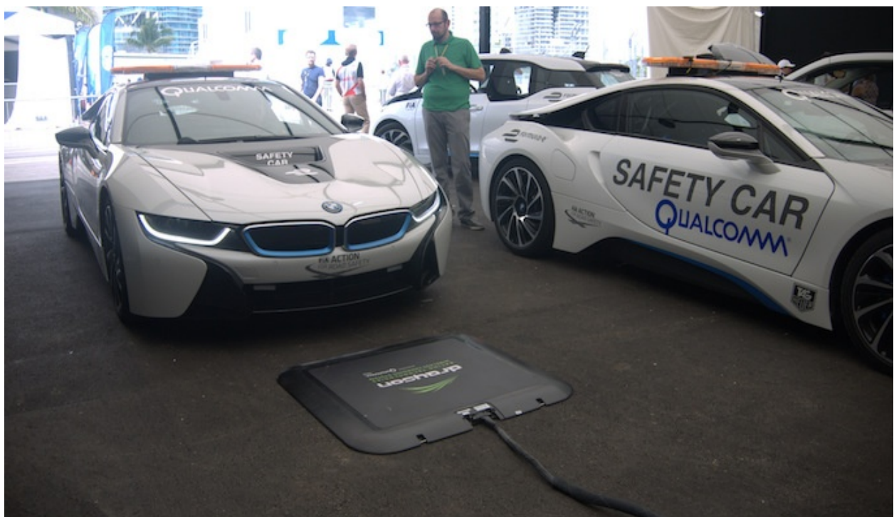
Εικόνα 7.7: Φορητός επαγωγικός φορτιστής για τα αυτοκίνητα ασφαλείας στη FormulaE
