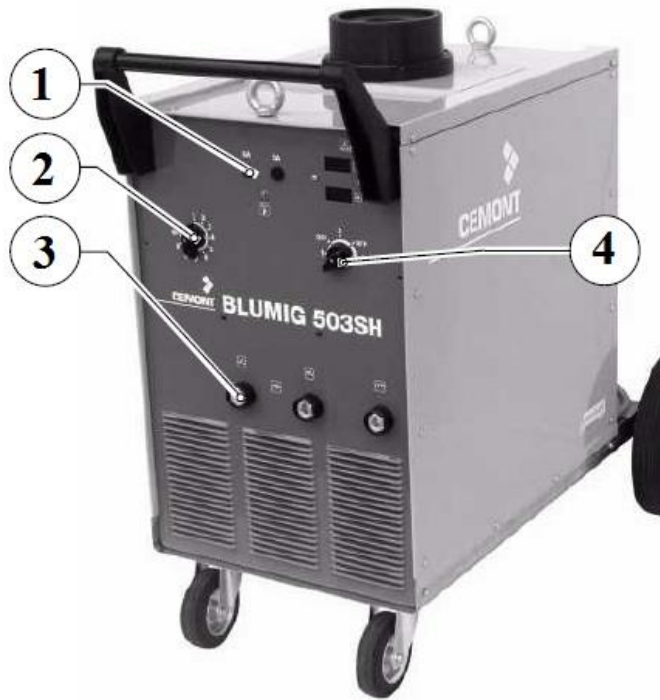
Σχήμα 5.1. Μηχανή Blumig 503SH, Cemont για συγκολλήσεις MIG/MAG 1) Ασφάλεια για το σύστημα έλξης, 2) Μεταλλάκτης ρύθμισης της τάσης συγκόλλησης, 3) Πρίζα καλωδίου γείωσης, 4) Διακόπτης τροφοδοσίας και μεταλλάκτης ρύθμισης.
