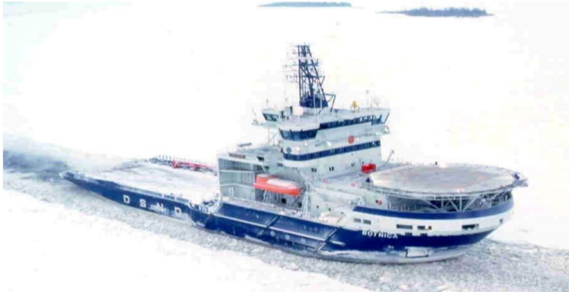
Σχήμα 3.12: “M/S Botnica”, Παγοθραύστης που λειτουργεί ως ένα σκάφος εφοδιασμού κατά τη θερινή περίοδο, εξοπλισμένο με πρόωση Azipod.
