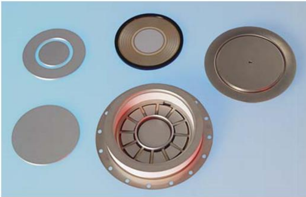
Σχήμα 3.21: Το IGCT “δίσκος χόκεϋ” άνοιξε, δείχνοντας τα συστατικά του. Τα όστια σιλικόνης είναι στην κορυφή (μεσαία).
