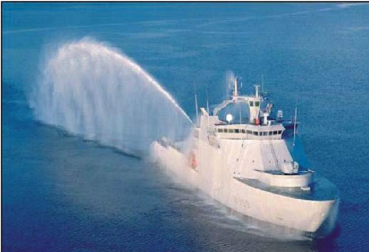
Σχήμα 3.14: “K/V Svalbard”, Παγοθραυστικό σκάφος ακτοφυλακής με υποκινούμενη πρόωση για το Νορβηγικό Πολεμικό Ναυτικό.
