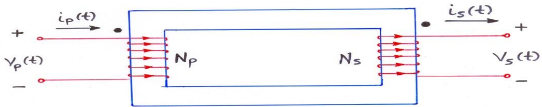
Σχήμα 4 : Διάγραμμα ενός πραγματικού Μ/Σ χωρίς φορτίο στο δευτερεύον
