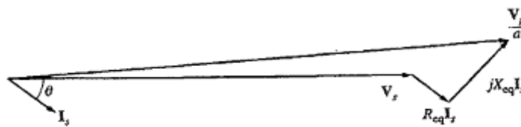
Σχήμα 15: Διανυσματικό διάγραμμα ενός μετασχηματιστή που λειτουργεί με επαγωγικό συντελεστή ισχύος.
