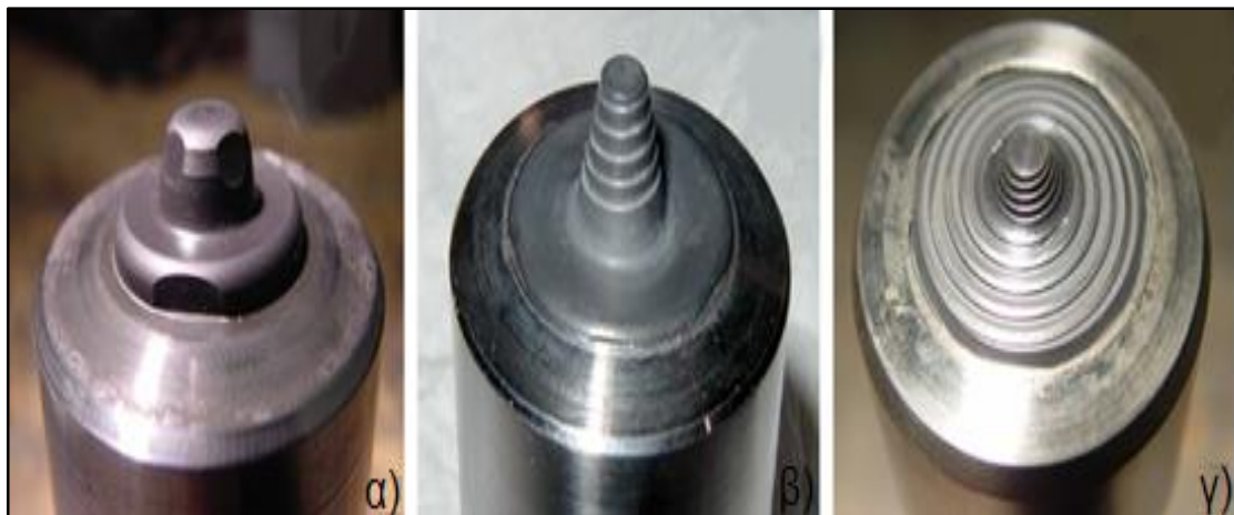
Εικόνα 5.1: Εξέλιξη σχεδιασμού εργαλείου PCBN: (α) πρώιμος σχεδιασμός χωρίς χαρακτηριστικά, (β) σπειροειδής ανιχνευτής βημάτων, και (γ) σπειροειδής κώνος [5]
