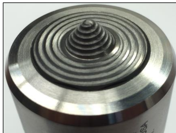
Εικόνα 5.8: Εργαλείο συγκολλήσεις με σπειροειδή μορφή στο πείρο και στο περιανθένιο
