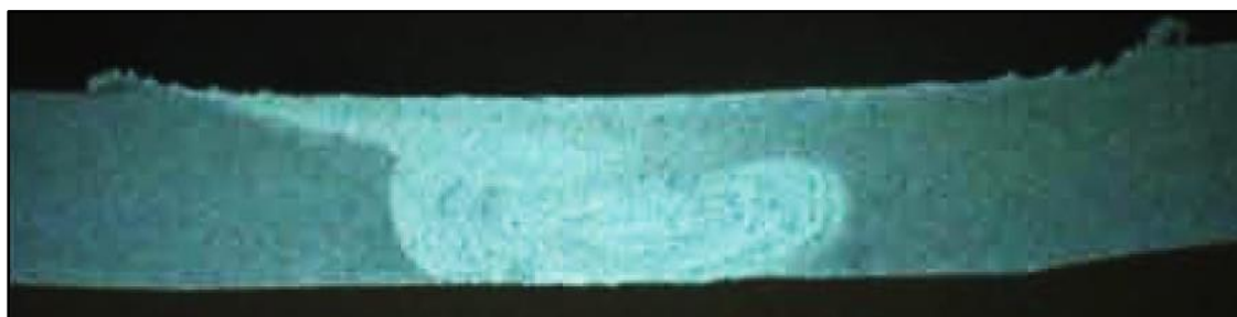
Εικόνα 6.4: Μικροδομή συγκόλλησης κατά την διαδικασία συγκόλλησης δια τριβής με ανάδευση
