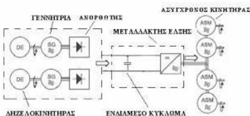
Σχήμα 22. Αρχή λειτουργίας της έλξης στις Δ/Η ADtranz
