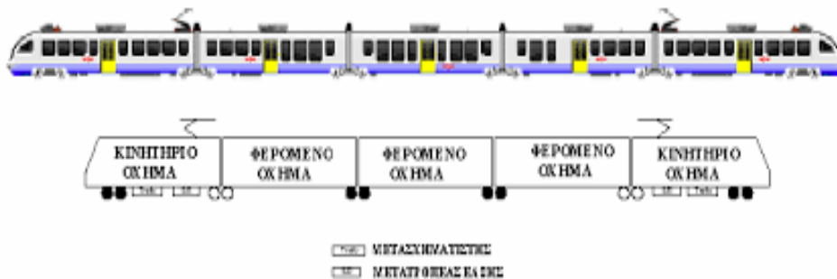
Εικόνα 22. Διάταξη του πεντάδυμου συρμού DESIRO SIEMENS
