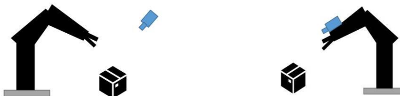
Εικόνα 1.10 8 Eye-to-hand και eye-in-hand διαδικασία.
