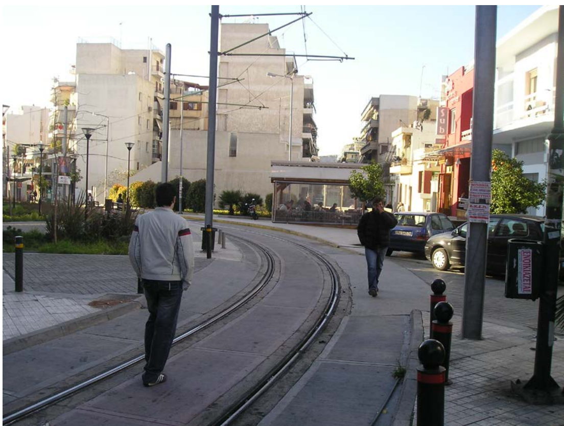
Εικόνα 10: Οι πεζοί διέρχονται από τον πεζόδρομο με πολύ μεγάλο κίνδυνο, καθώς πέρα από τη σειρήνα του τραμ κατά τη διέλευσή του, δεν υπάρχει φωτεινός σηματοδότης
