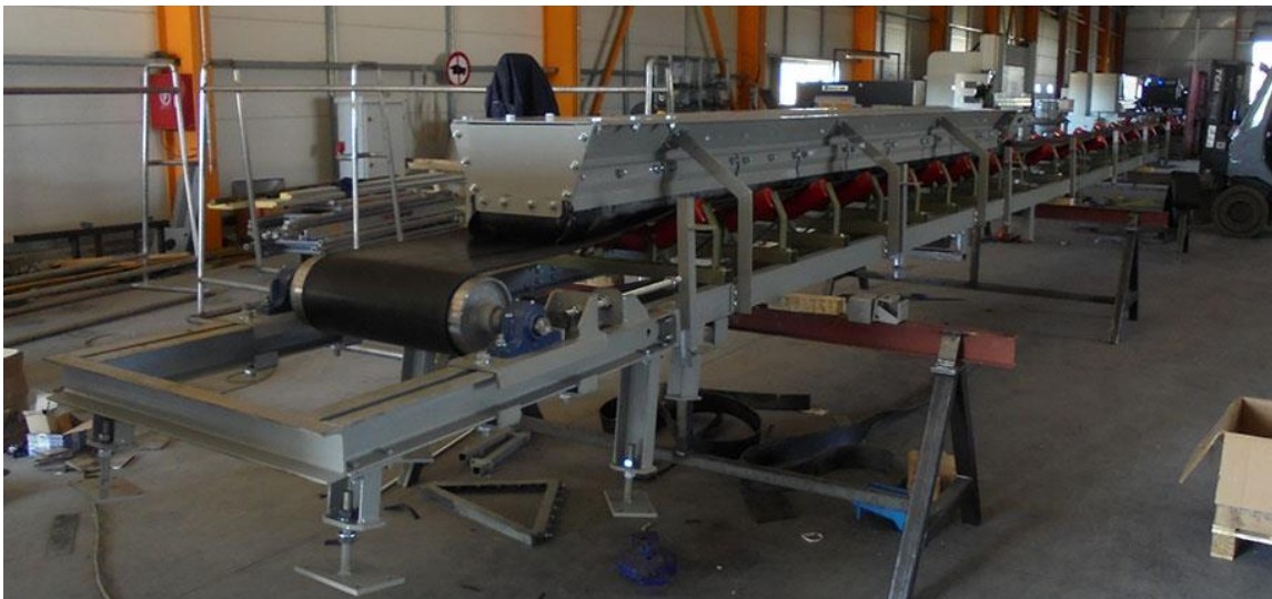
Εικόνα 3. Ταινιόδρομος σε βιομηχανία
