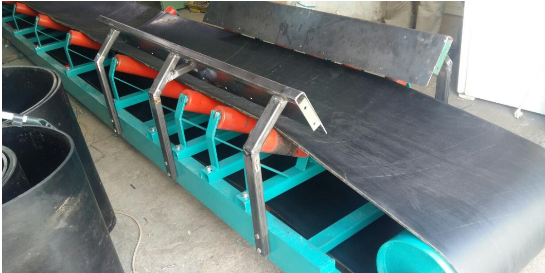
Εικόνα 4. Ταινία με ράουλα σε βιομηχανική εγκατάσταση
