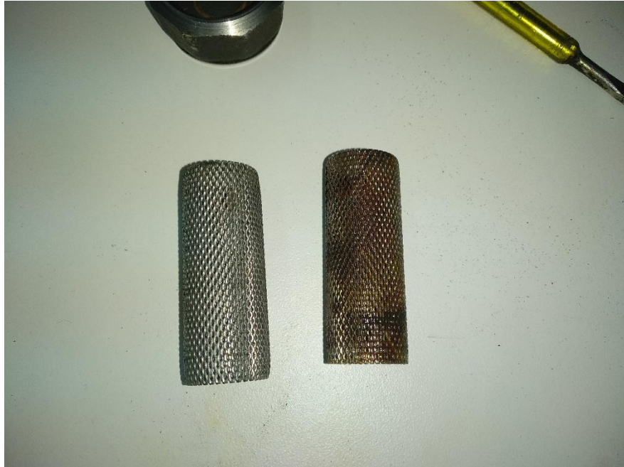
Εικόνα 44: Πριν και μετά τον καθαρισμό των φίλτρων
