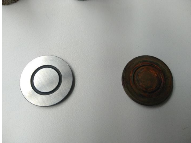
Εικόνα 42: Καινούρια βαλβίδα και παλιά βαλβίδα
