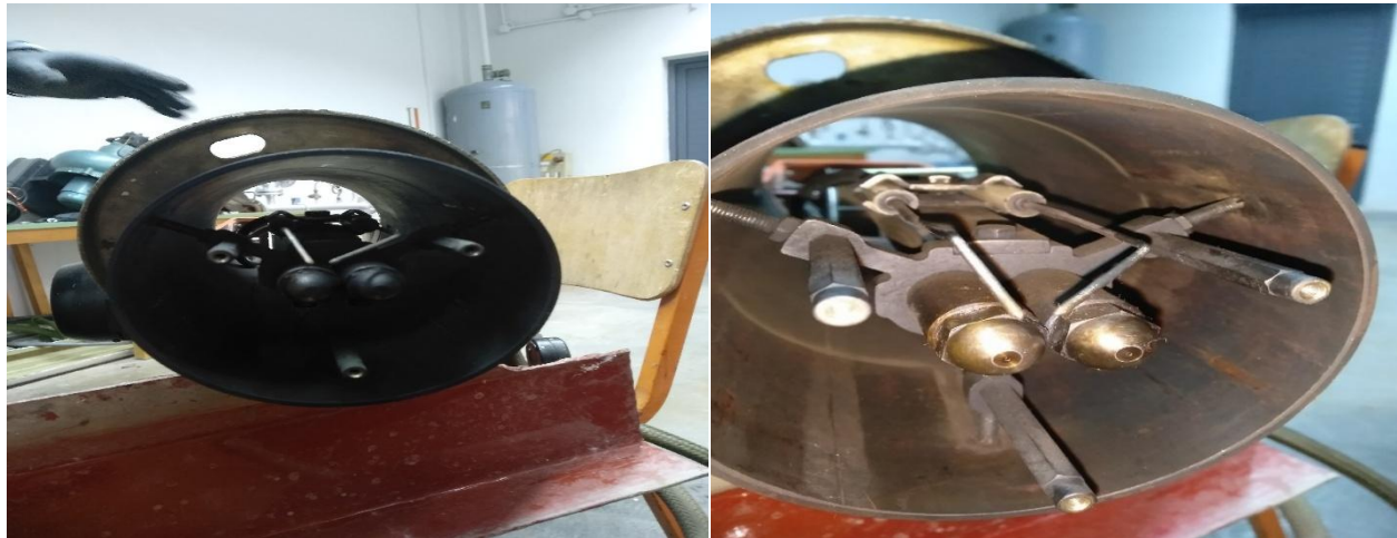
Εικόνα 18: Καυστήρας πριν μετά τον καθαρισμό
