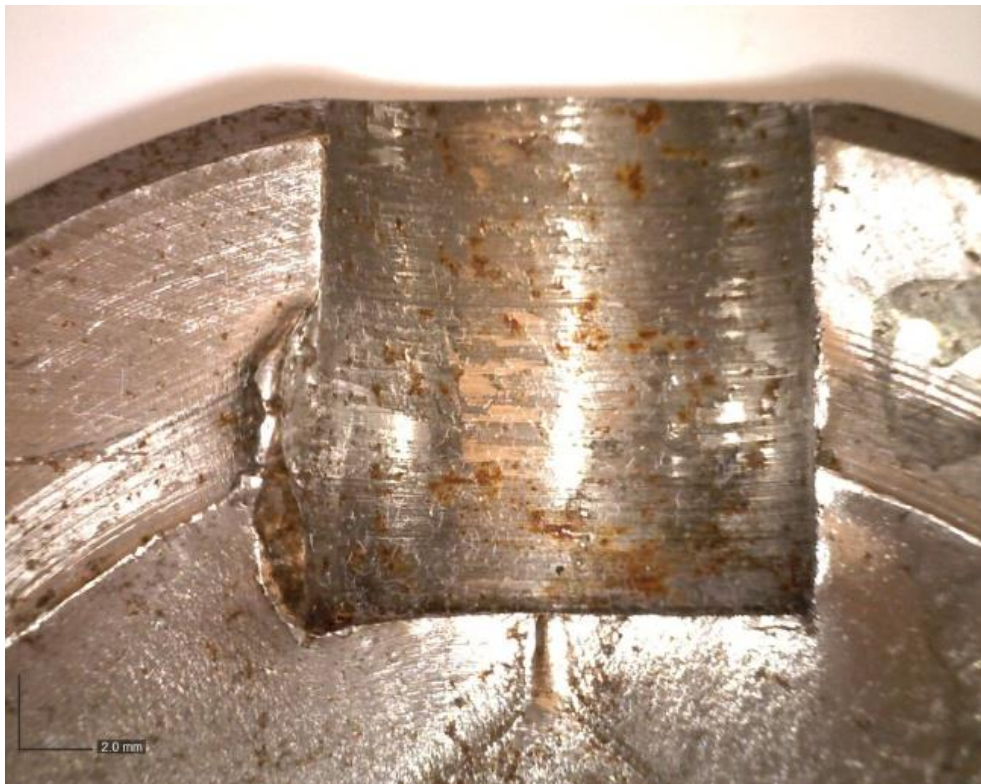
Εικόνα 7:5 Φωτογραφία οπτικής στερεοσκοπίας στο σημείο θραύσεως κάτω από τη σφηνάουλακα
