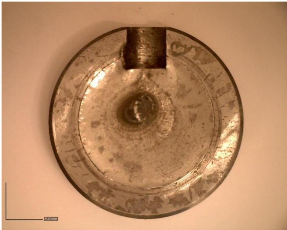
Εικόνα 7:3 Φωτογραφία οπτικής στερεοσκοπίας στο σημείο θραύσεως
