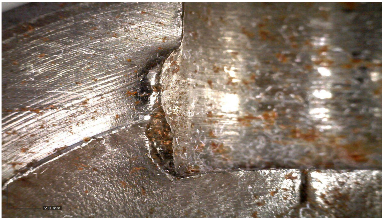
Εικόνα 5:2 Φωτογραφία μεγάλης ευκρινείας της επιφάνειας θραύσης του υπό εξέταση κομματιού.
