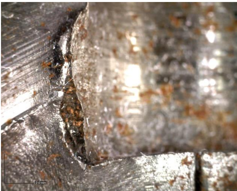
Εικόνα 7:5 Φωτογραφία οπτικής στερεοσκοπίας στο σημείο θραύσεως κάτω από τη σφηναύλακα
