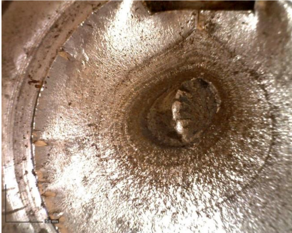
Εικόνα 7:4 Φωτογραφία οπτικής στερεοσκοπίας στο σημείο θραύσεως στο κέντρο του άξονα
