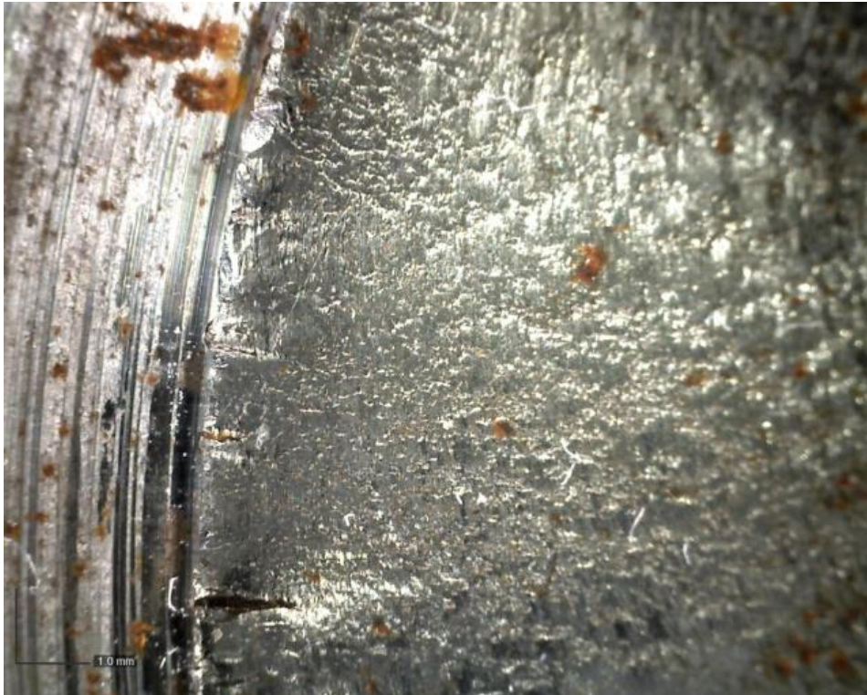
Εικόνα 7:4 Φωτογραφία οπτικής στερεοσκοπίας στο σημείο θραύσεως
