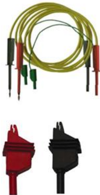
Εικόνα 16: Ειδική αγωγοί για την μέτρηση των μονωτήρων
