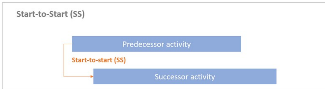
Εικόνα 4: Απεικόνιση σχέσης SS (Πηγή: https://project-management.info/pdm-precedence-diagramming-method/ )
