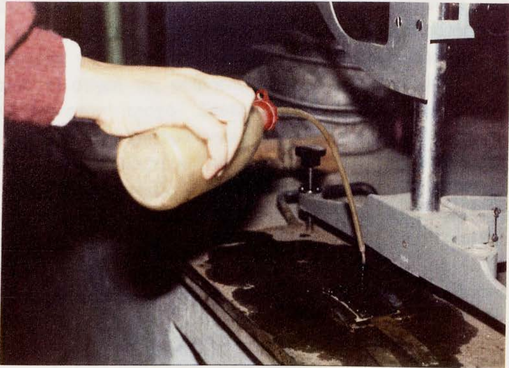
Φώτο 5 : Συνεχής διαβροχή κατά την διάρκεια της δοκιμής.
