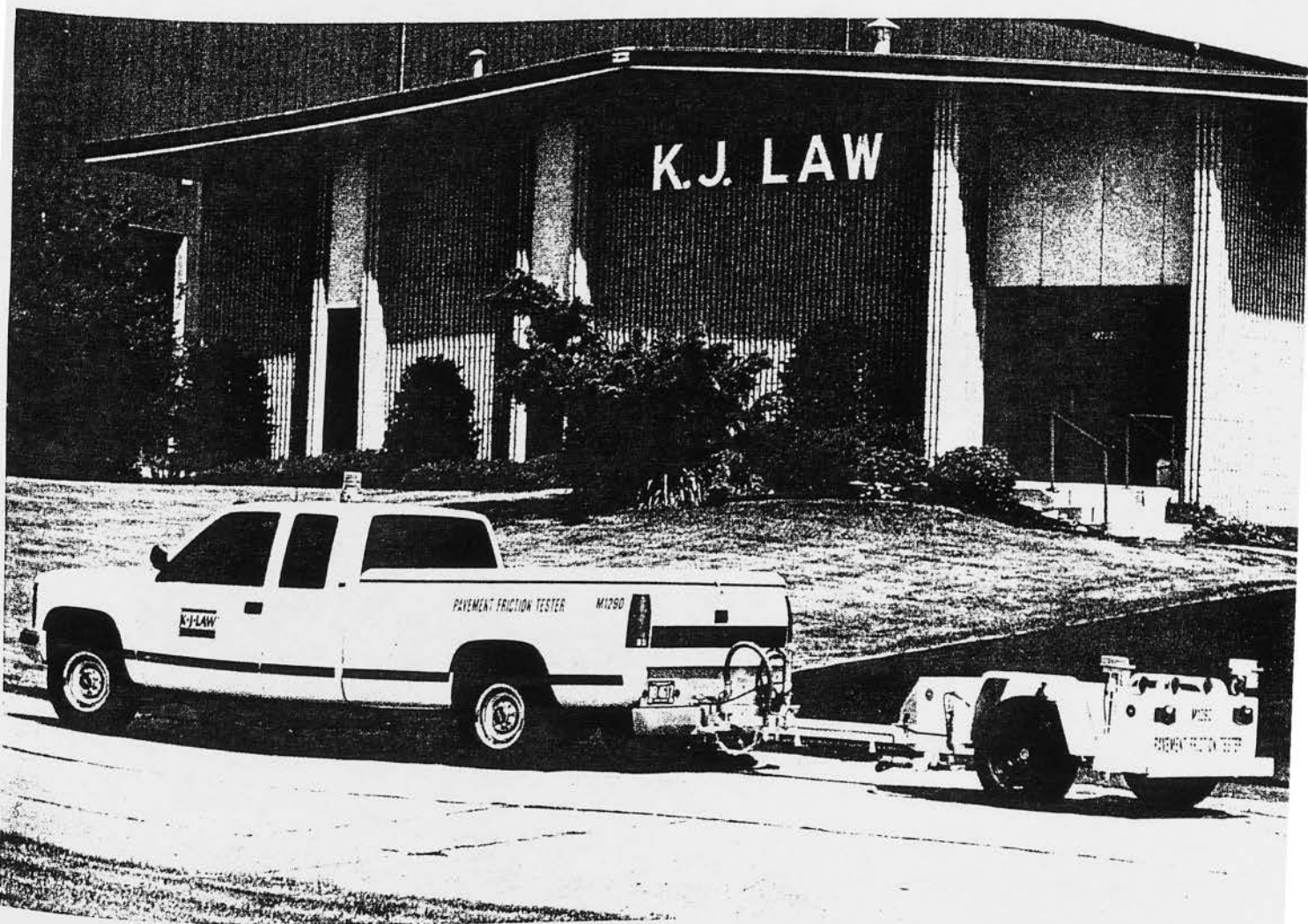
ΦΩΤΟ 7 : Ένα από τα τελευταία μοντέλα αυτοκινούμενων οχημάτων (trailer : COMPUTER CONTROLLED PAVEMENT FRICTION TESTER - MODEL 1290 )
