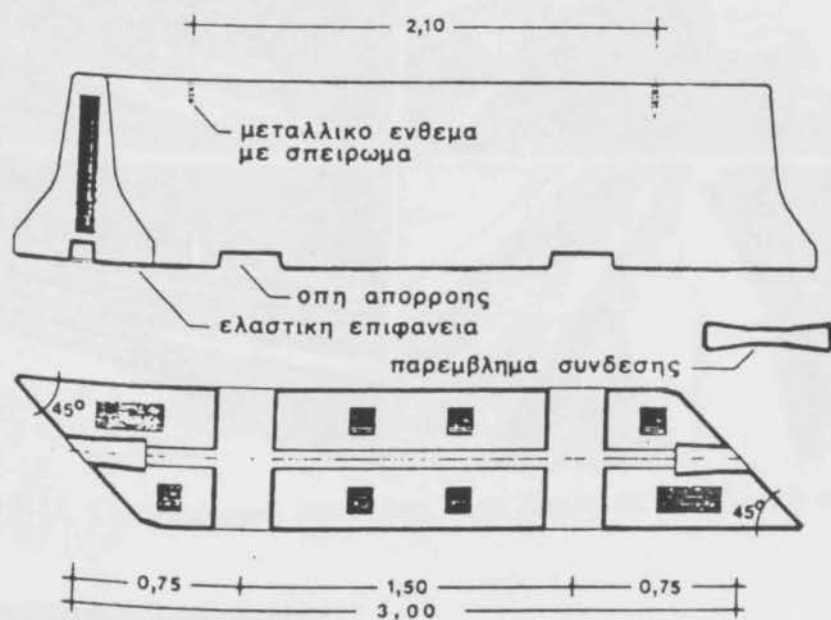
Εικόνα 5.12 :Προκατασκευασμένο στοιχείο στηθαίου ασφάλειας με αμφίπλευρη διατομή New Jersey (σύστημα Reiff)
