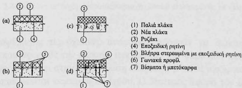
Σχ.3.23. Ενίσχυση πλακών με πρόσθετες στρώσεις σκυροδέματος. Εναλλακτικοί τρόποι σύνδεσης στην διεπιφάνεια
