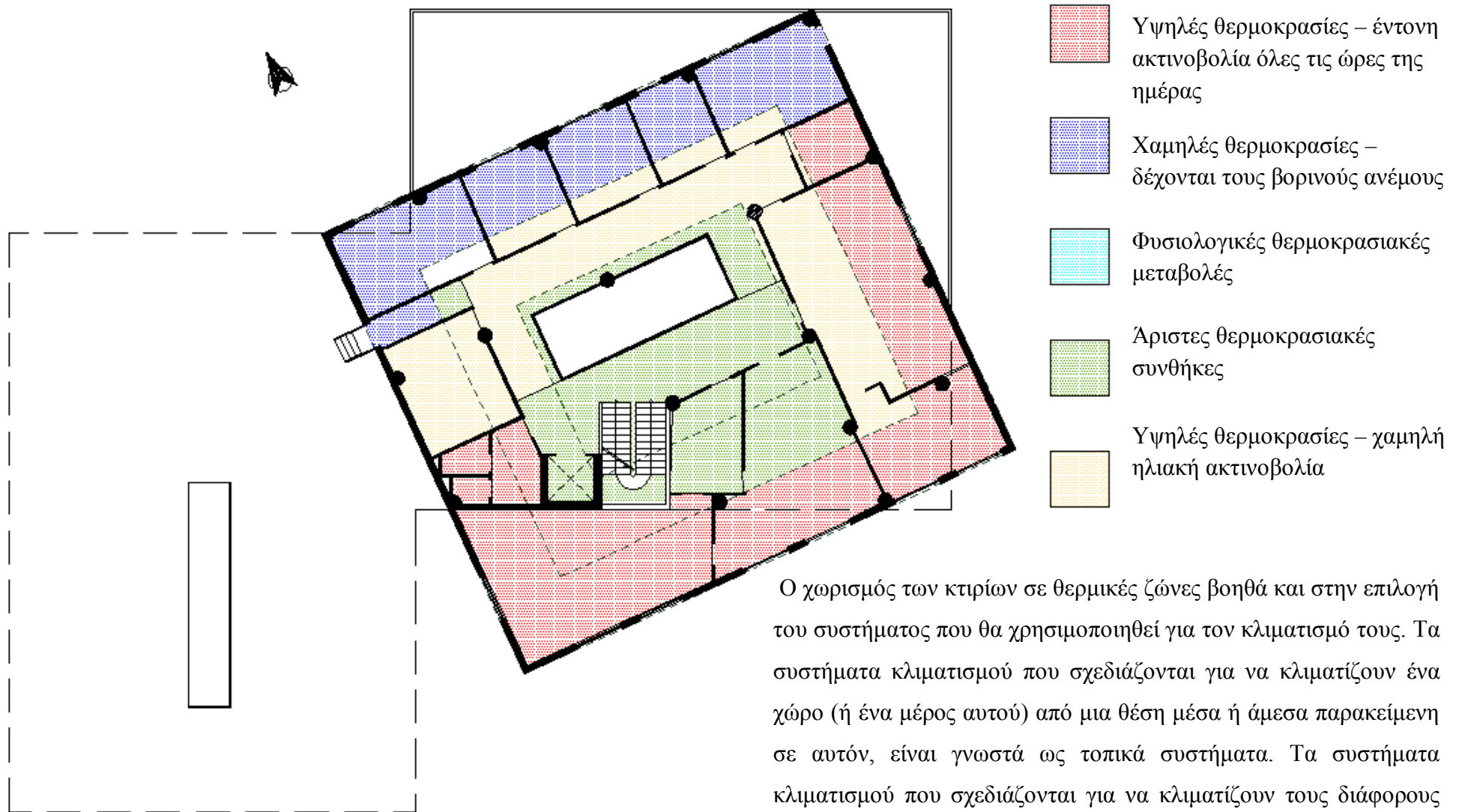
Εικόνα 35 Θερμικές ζώνες ορόφου κτιρίου διοίκησης
