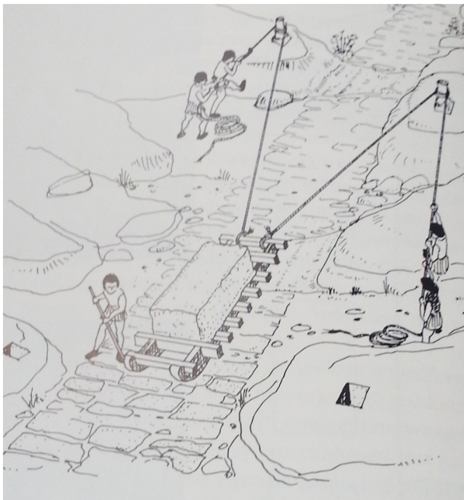
Εικόνα 53. Κατάβαση ογκόλιθου από λατομείο. (Πηγή βιβλίο Wolfgang Muller – Wiener H ARCHITEKTONIKH ΣΤΗΝ ΑΡΧΑΙΑ ΕΛΛΑΔΑ)
