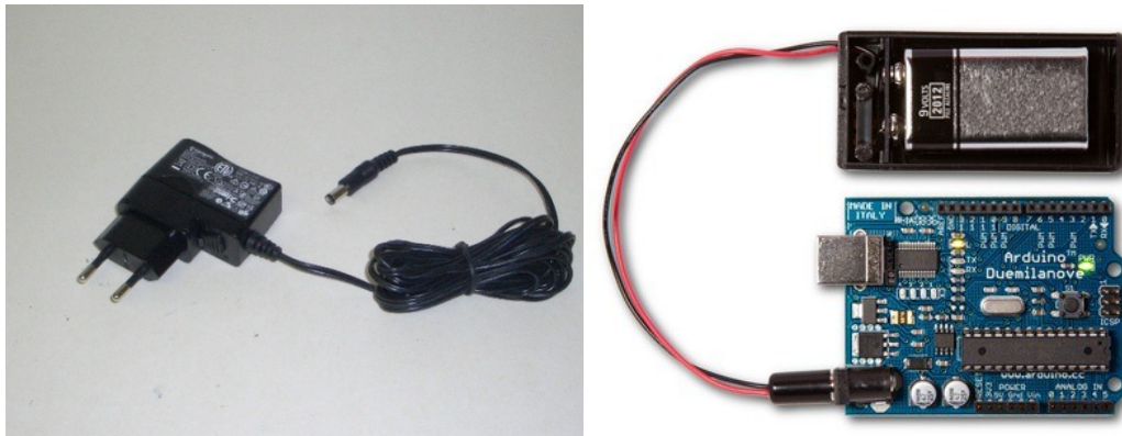
Εικόνα 64 , 65: Τροφοδοσία με DC προσαρμογέα ή με αλκαλική μπαταρία.
