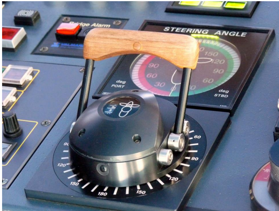
Σχήμα 5.12 Φωτογραφία των χειριστηρίων του αζιμουθιακού συστήματος από τη γέφυρα του πλοίου
