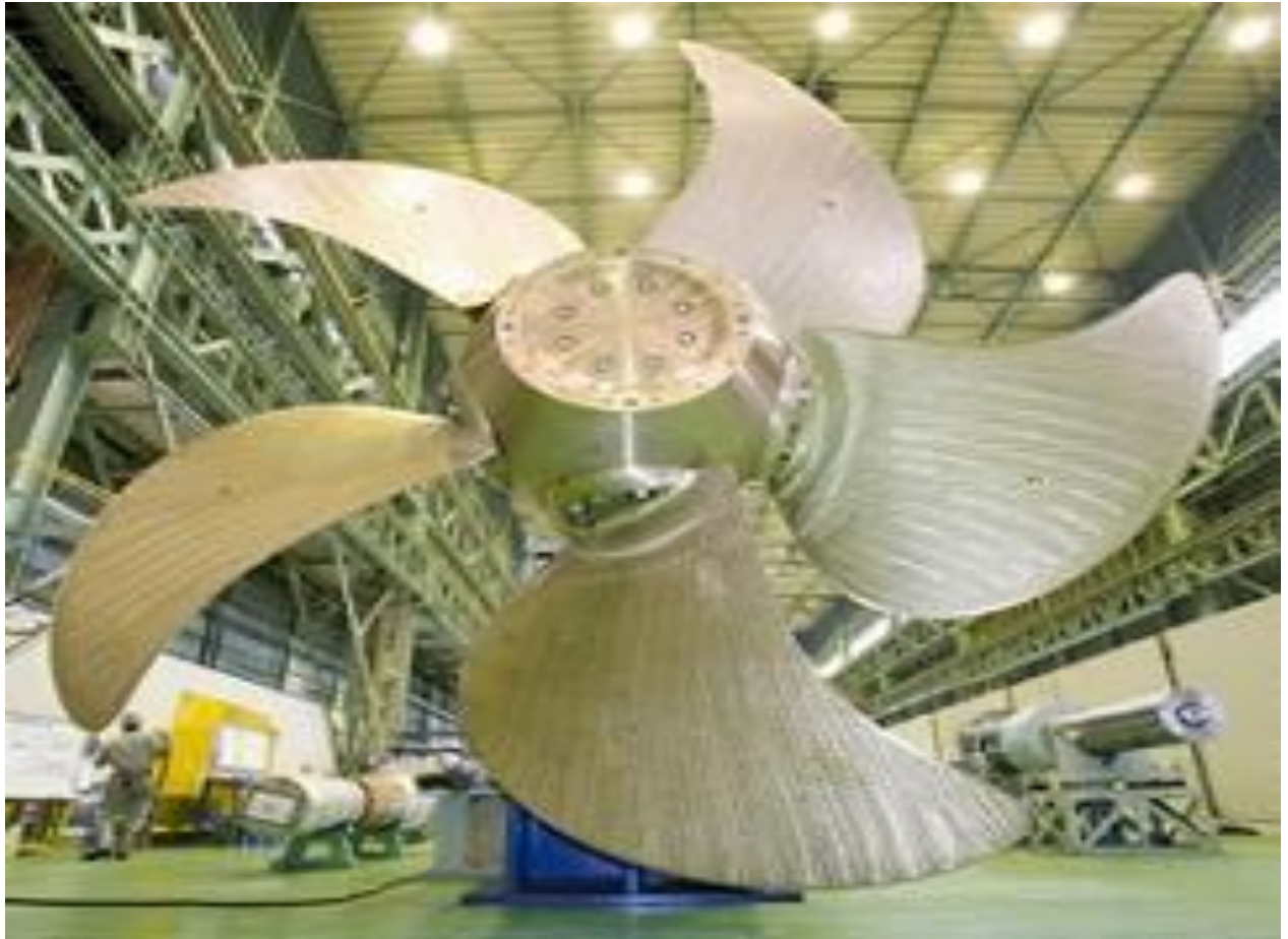
Σχήμα 4.3 Φωτογραφία προπέλας μεταβλητού βήματος όπου διακρίνονται τα μέρη της
