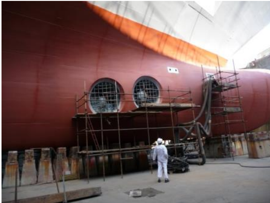
Σχήμα 7.1 Φωτογραφία της πλώρης ενός πλοίου και της πρωραίας έλικας χειρισμών
