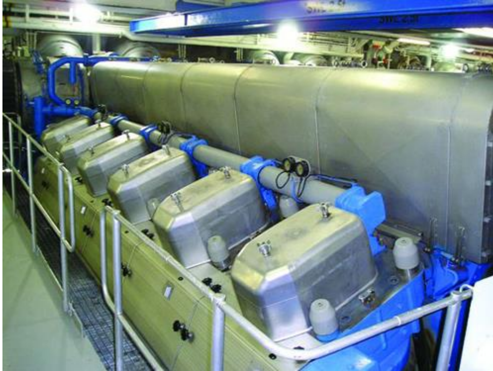
Σχήμα 2.2 Φωτογραφία των κυλίνδρων σε μηχανή τύπου V
