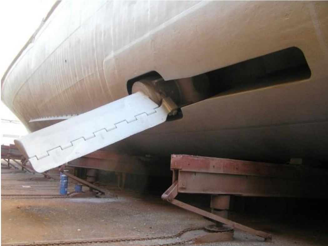
Σχήμα 7.2 Φωτογραφία του stabilizer ενός πλοίου
