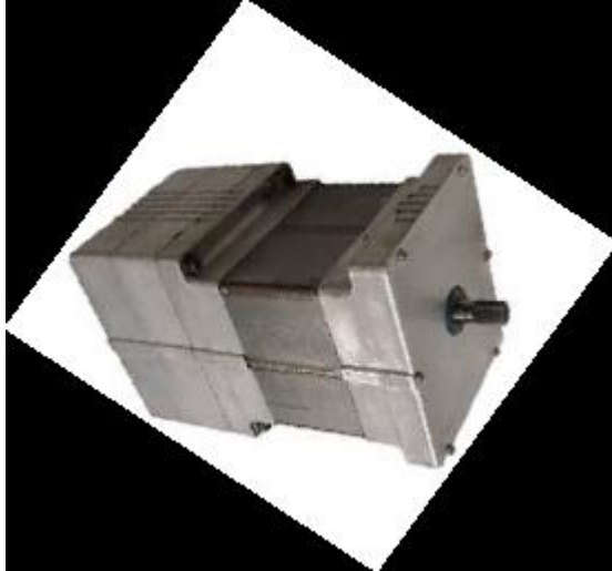
Σχήμα 3.6 Εικόνα από Επενεργητής(Actuator) ProAct Σερβοκινητήρα συστήματος ελέγχου στροφών. Οι ρυθμίσεις γίνονται μέσω συστήματος ψηφιακού ελεγκτή/HY. Περιέχει ελεγκτή θέσης περιστροφής.
