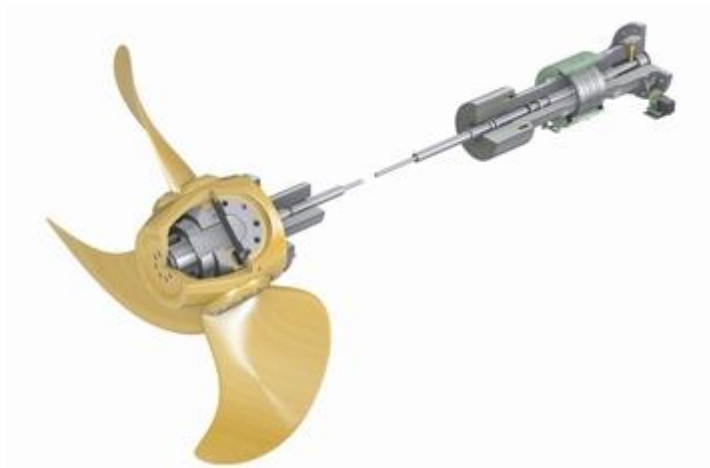
Σχήμα 4.4 Εικόνα παρουσίασης της λειτουργίας μιας προπέλας μεταβλητού βήματος
