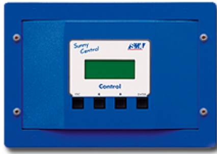
Σχήμα 4.2 Διάταξη συλλογής και διαχείρισης δεδομένων Sunny Central Control [4]
