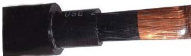
Σχήμα 3.29 Τυπική δομή καλωδίου H07RN-F [6]
