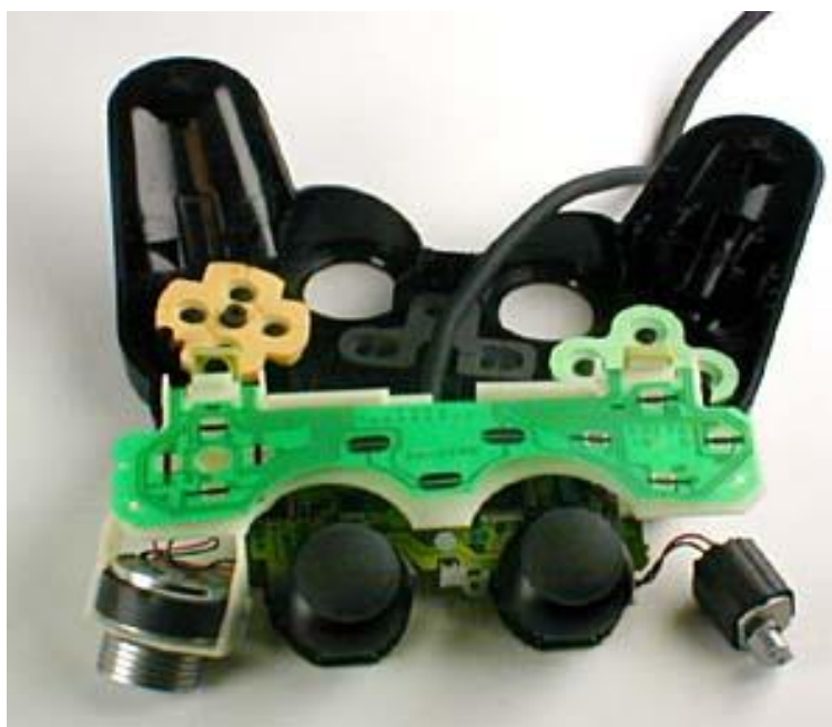
Σχήμα 36 Εσωτερική δομή του χειριστηρίου
