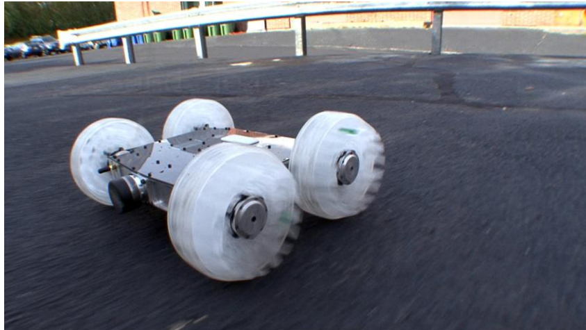
Σχήμα 11 Τηλεκατευθυνόμενο όχημα με δυνατότητα υπερπήδησης εμποδίων
