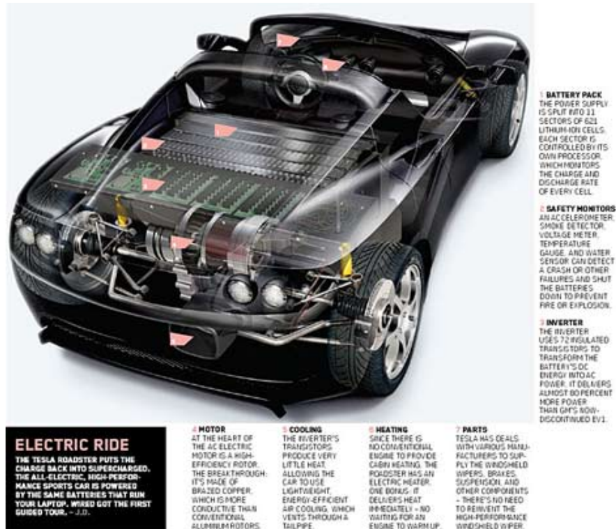
Εικόνα 1.8 Tesla Roadster Batteries
