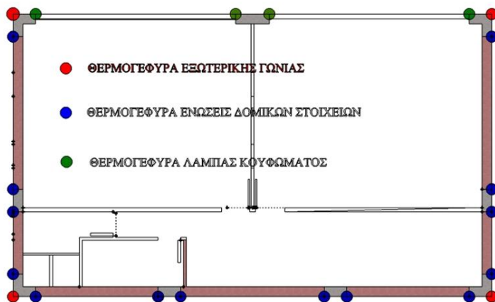
Σχήμα 3.22 Απεικόνιση των θερμογεφυρών στη κάτοψη τυπικού ορόφου
