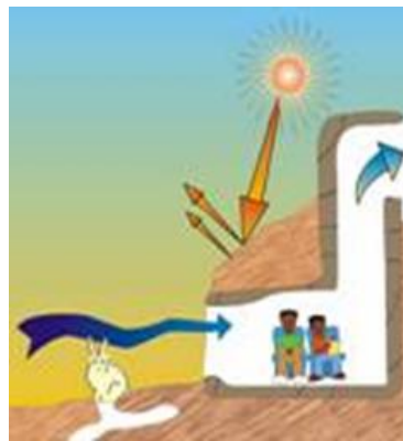
Σχήμα 1.57 Δροσισμός υπόσκαφου κτιρίου
