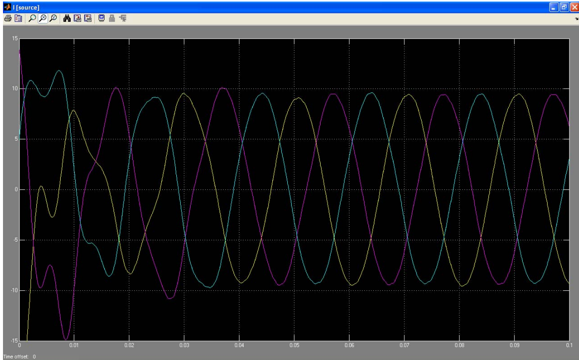
Εικόνα 5.37 Ρεύμα στις έξοδο του δικτύου
