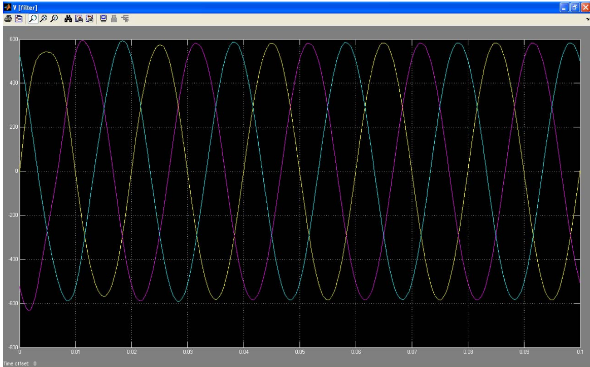
Εικόνα 5.31 Τάση στην έξοδο του αντιστροφέα μετά το φίλτρο
