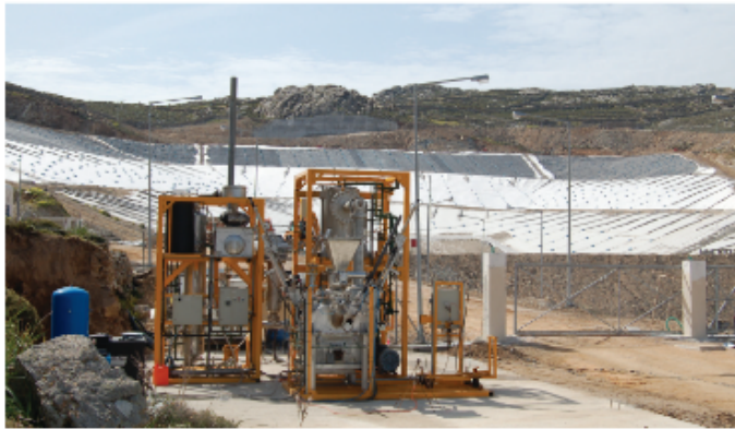
ΠΩΣ ΛΕΙΤΟΥΡΓΕΙ Η ΜΟΝΑΔΑ ΑΕΡΙΟΠΟΙΗΣΗΣ
