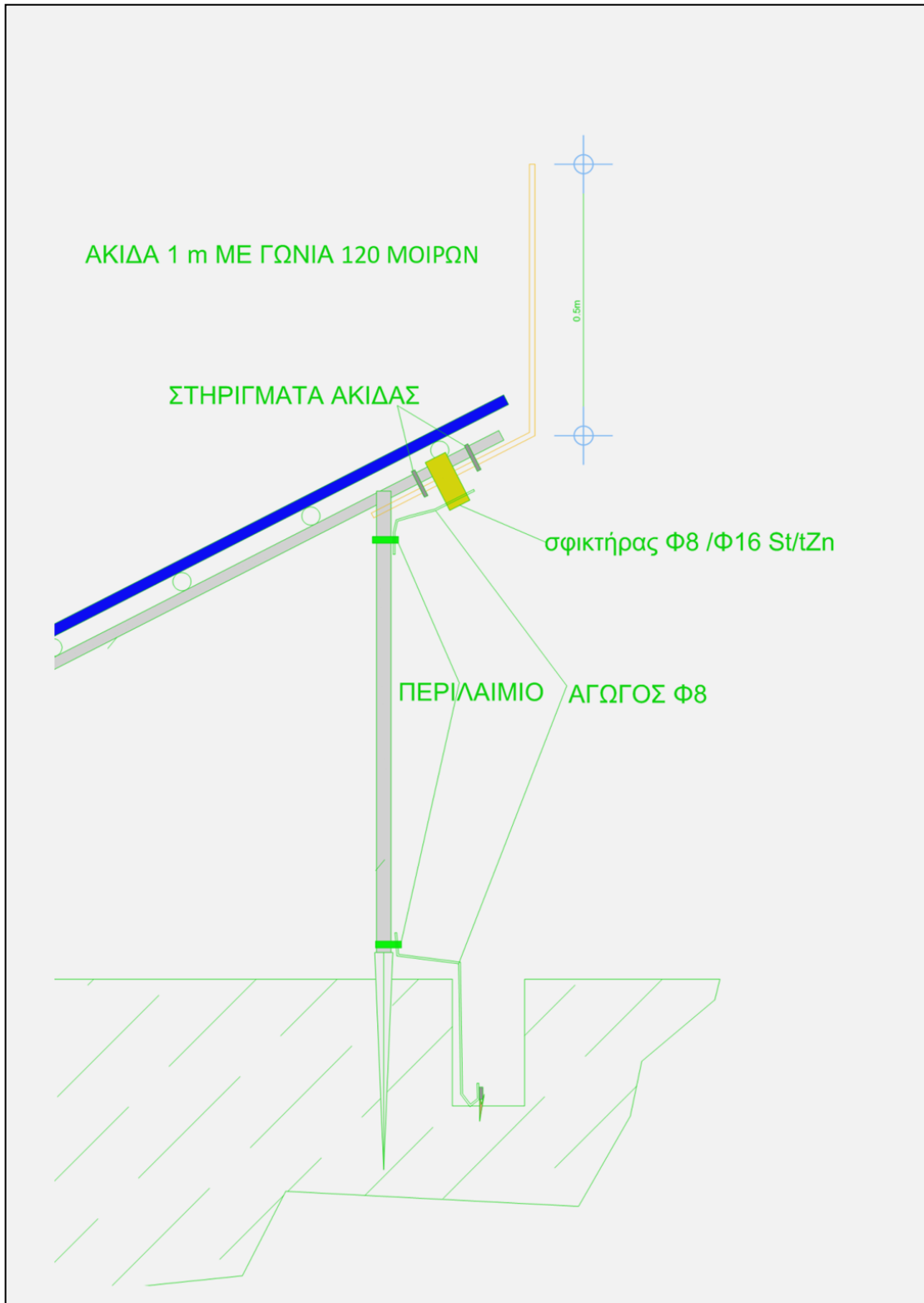
Σχήμα 5.11 Αντικεραυνική ακίδα υπό γωνία 120° πακτωμένη επί βάσεως
