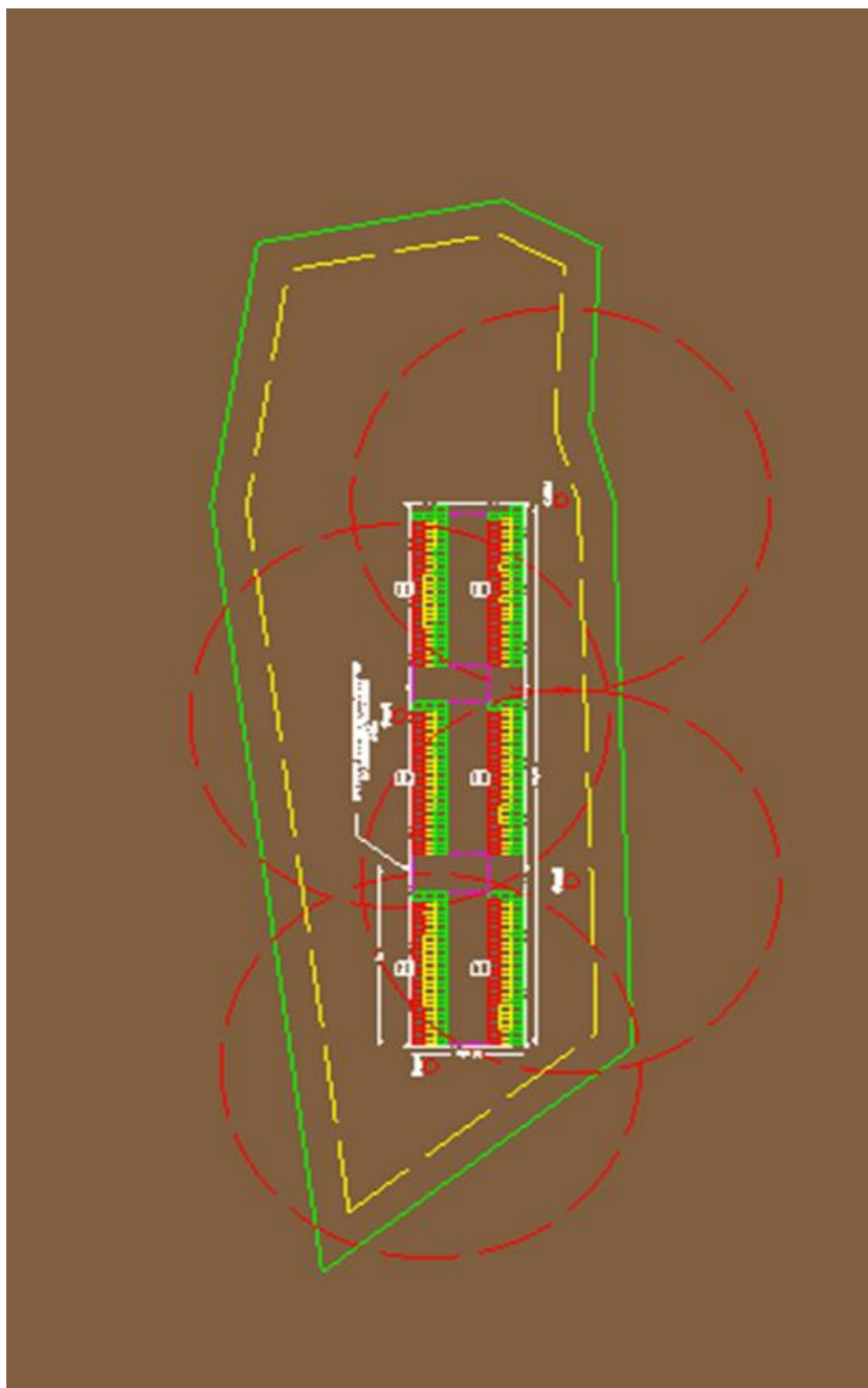
Σχηματική αναπαράσταση του Φ/Β πάρκου μέσω AutoCad
