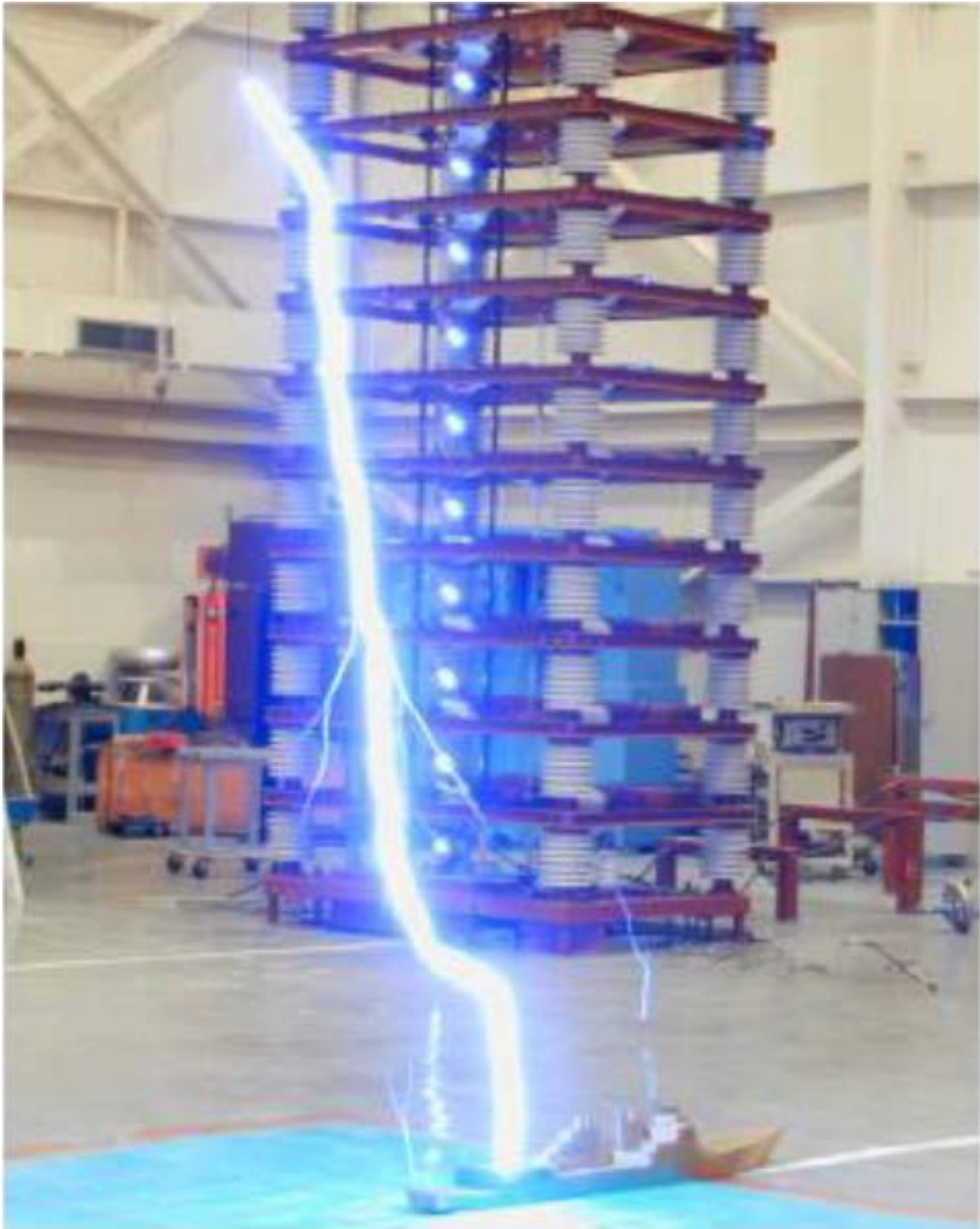
Σχήμα Β13 Κεραυνός καταλήγει σε προστατευόμενο αντικείμενο.
