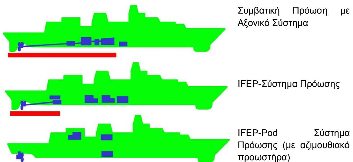
Σχήμα A23. Συγκριτική παρουσίαση αξονικών συστημάτων πλοίων
