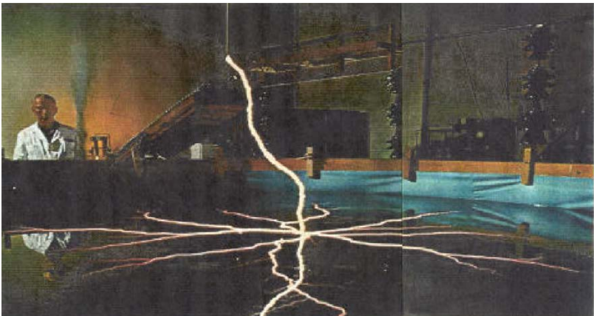
Σχήμα B18 Φωτογραφία εκφόρτισης μίας δεξαμενής νερού στο πανεπιστήμιο του Colorado
