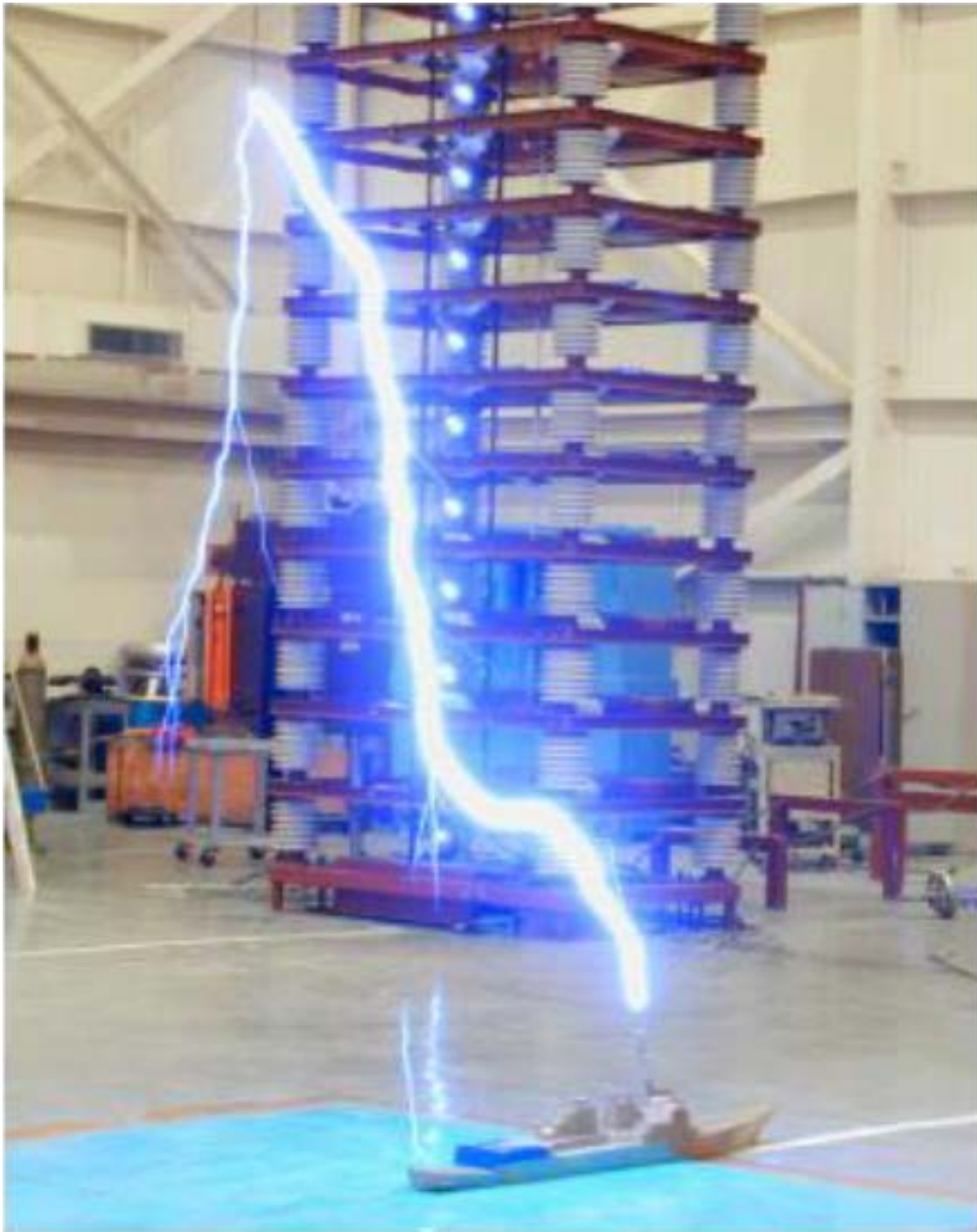
Σχήμα B12 Κεραυνός καταλήγει στο αλεξικέραυνο του μοντέλου πλοίου.
